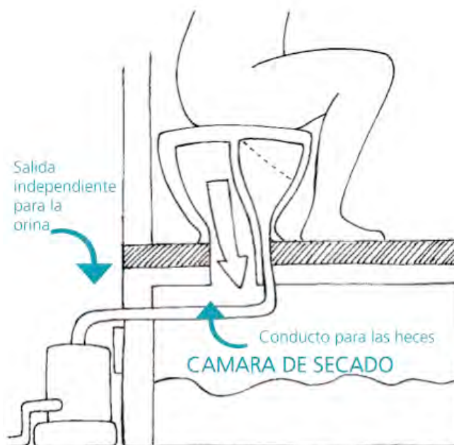
Figura 38. Mecanismo de un baño seco. Fuente: Ecotec, 2018.
