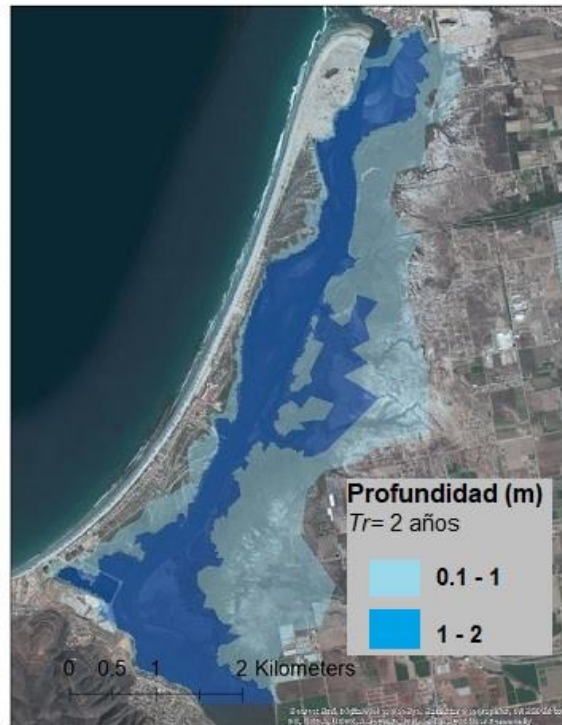
Figura 49. Comparación entre condiciones normales y condiciones extremas Tr= 2 años para la zona del estero de Punta Banda. Se muestra que la mancha de inundación se extiende sobre la planicie de inundación con profundidades menores a 1 m.
