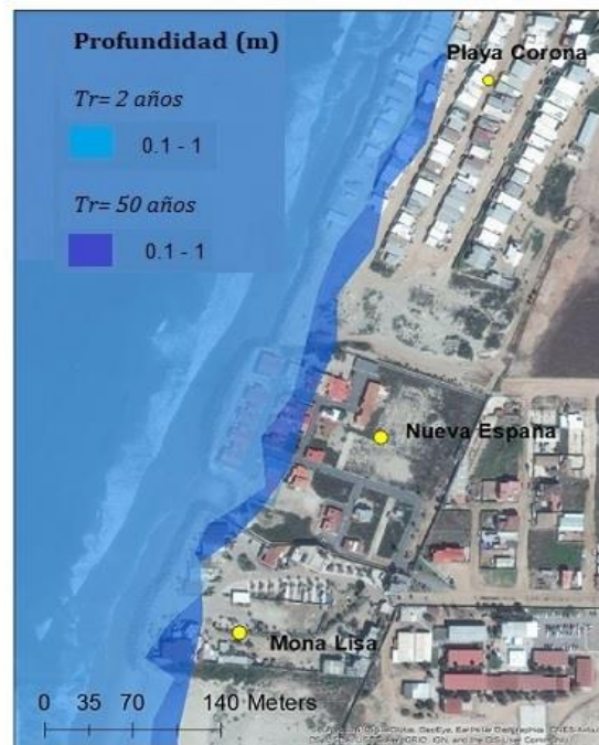
Figura 38. Comparación entre los resultados de inundación Tr= 2 y 50 años para las playas Corona, Nueva España y Mona Lisa. El nivel del agua alcanza la cota topográfica de 4 m con una lámina de inundación que se extiende tierra adentro para ambos periodos de retorno con profundidades menores a 0.5 m.
