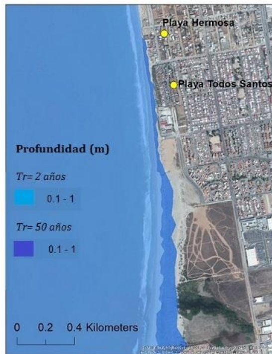
Figura 37. Área de playa Hermosa. La mancha de inundación para el Tr= 50 años se extiende sobre la playa (particularmente hacia el sur de playa Todos Santos), pero se mantiene por debajo del nivel topográfico sobre el que se ubica la infraestructura habitacional.
