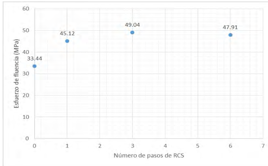
Figura 4.3.3 Representación gráfica de los resultados del esfuerzo de cedencia Vs número de pasos de deformación RCS para la aleación de aluminio 1100.
