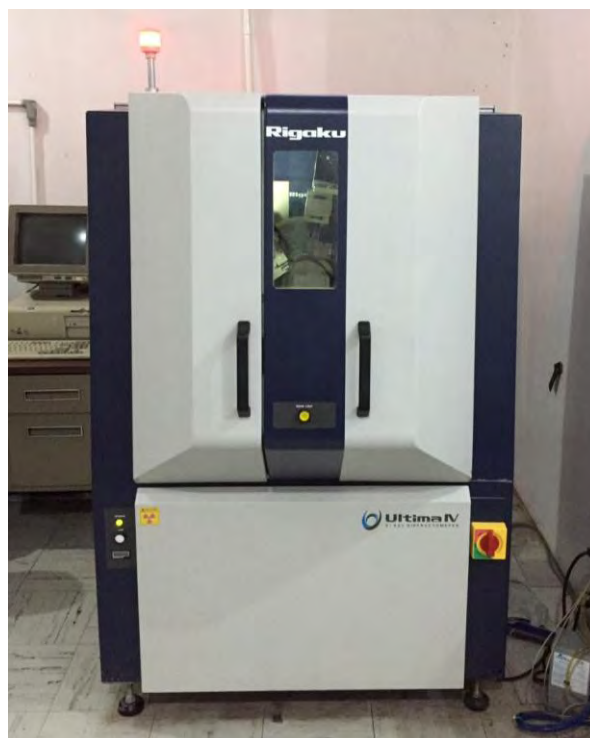
Figura 3.3.3 Difractómetro de RX empleado para la medición de figuras de polo y esfuerzos residuales. Marca: Rigaku Modelo: Ultima IV
