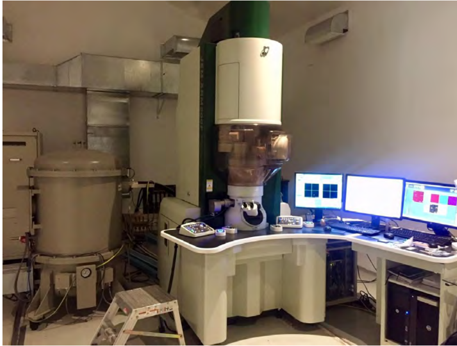
Figura 3.3.2.1 Microscopio electrónico de transmisión empleado para análisis microestructural. (Morfología y evolución microestructural)
