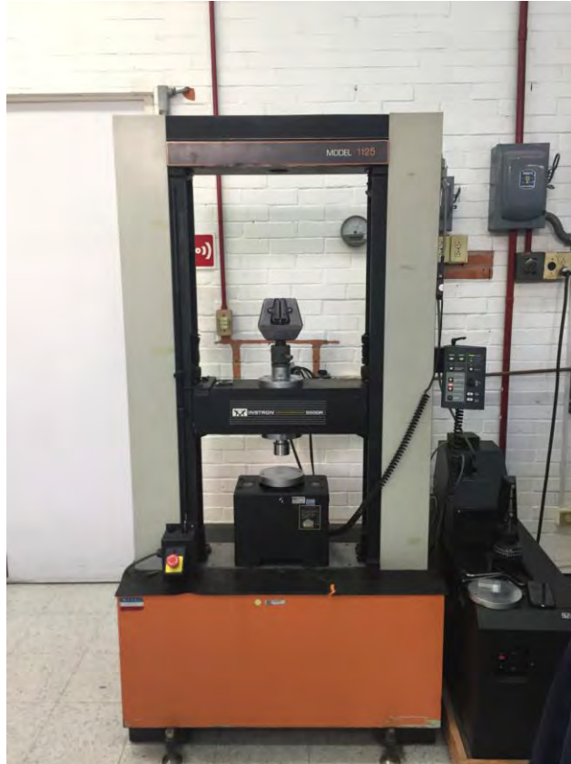
Figura 3.2.3 Máquina de ensayos universales empleada para la técnica de Corrugado y Planchado, así como para los ensayos tracción. Marca: Instron. Modelo: 1125.
