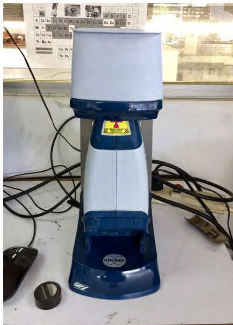
Figura 3.3.1.0 Equipo de XRF empleado para análisis químico elemental. Marca: Bruker Modelo: Titan s1
