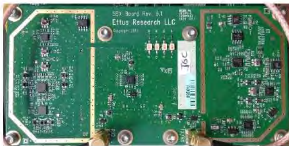
Figura 10: Tarjeta hija del USRP 2932. En Turbo envió: Una estrategia de retransmisión rápida para enviar paquetes en redes inalámbricas AD HOC , Jaimes, B. O. 2017.
