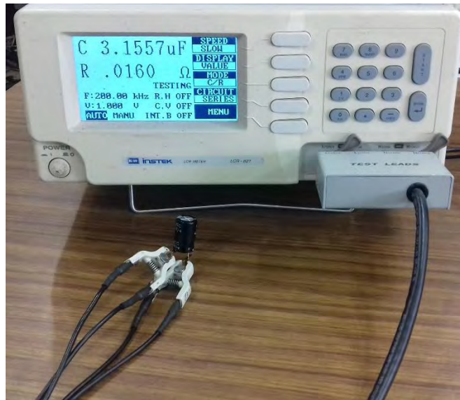
Figura 4.2.3. Resistencia interna del capacitor “ R_{ESR} ”.
