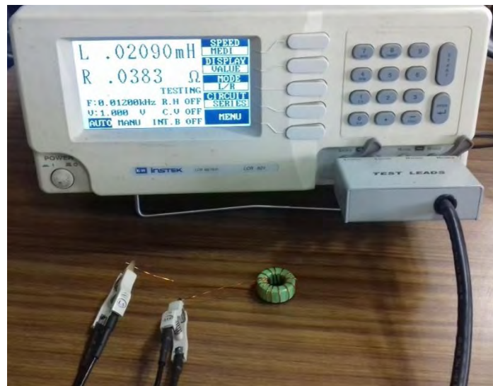
Figura 4.2.4. Resistencia interna del Inductor “ R_L ”.
