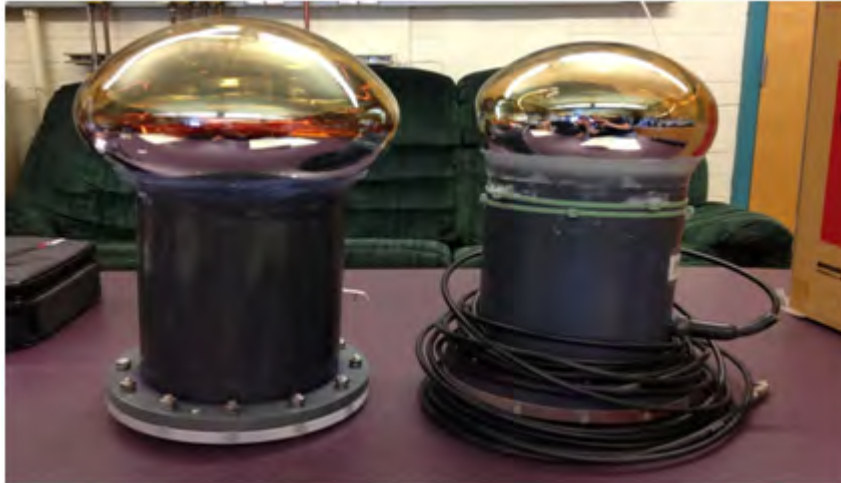
FIGURA 4.6: Muestra de los dos modelos de tubos fotomultiplicadores en HAWC. De izquierda a derecha; el de 10 pulgadas (R7081) y de 8 pulgadas (R5912) de diámetro en cada uno de los 300 tanques que conforman el observatorio.
