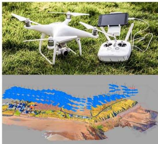
Imagen 26: Dron DJI Phantom 4 y levantamiento 3D de un terreno. Imágenes: espertreviews.com (Derecha) y questuav.com (Izquierda). <sup>34</sup>
