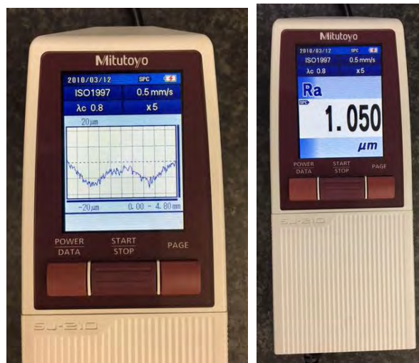
Figura 3. Lectura de rugosidad Ra (Ortega & Soladana. 2018).
