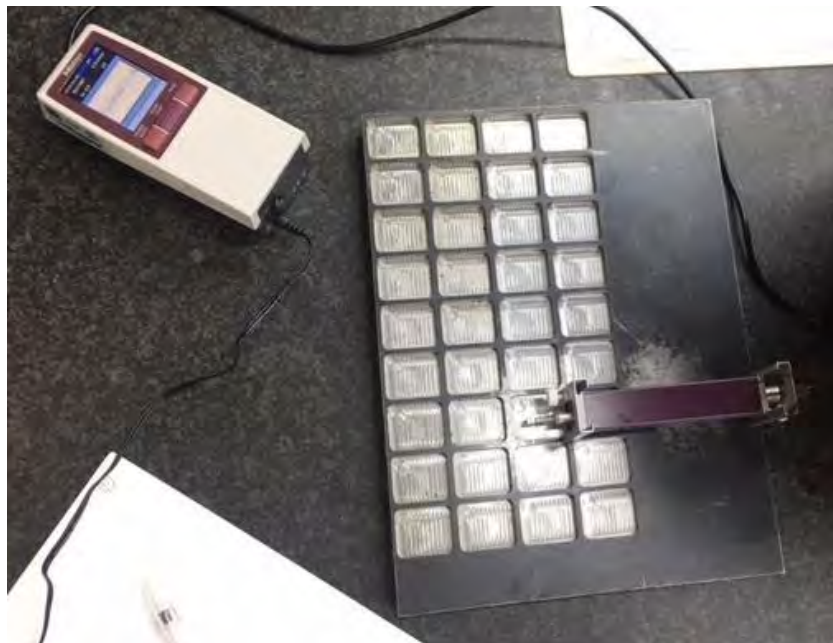
Figura 2. Medición de rugosidad superficial en cavidades (Ortega & Soladana. 2018).
