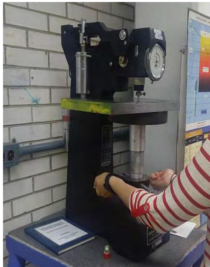
Figura 8. Calibración de durómetro (Ortega & Soladana. 2018).
