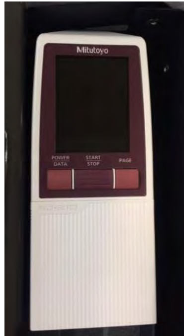
Figura 1. Rugosímetro Mitutoyo® (Ortega & Soladana. 2018).
