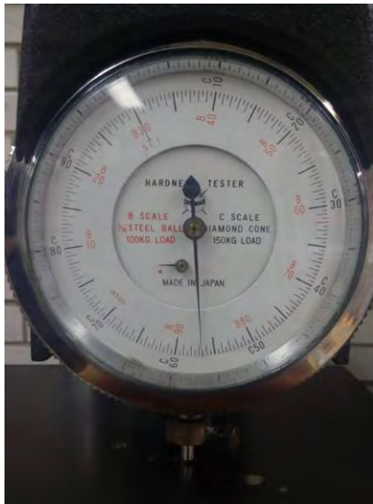
Figura 9. Lectura de dureza (Ortega & Soladana. 2018).
