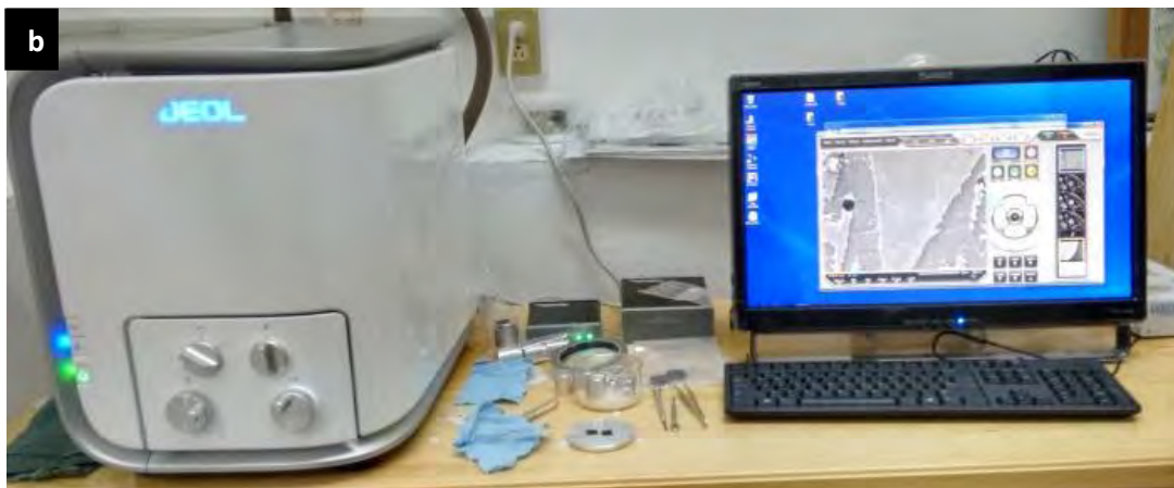
Figura 2.10 a) Microscopio óptico. Con el cual se obtienen imágenes superficiales a bajos aumentos, incluye cámara digital con software para análisis fotográfico. b) MEB, usado para la obtención de fotomicrografías, análisis EDS y Mapeos.
