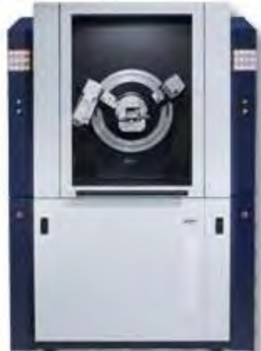
Figura 2.8 Difractómetro de rayos X, marca Bruker, modelo: D8 advance. Con el cual se conocen las fases presentes en cada aleación.
