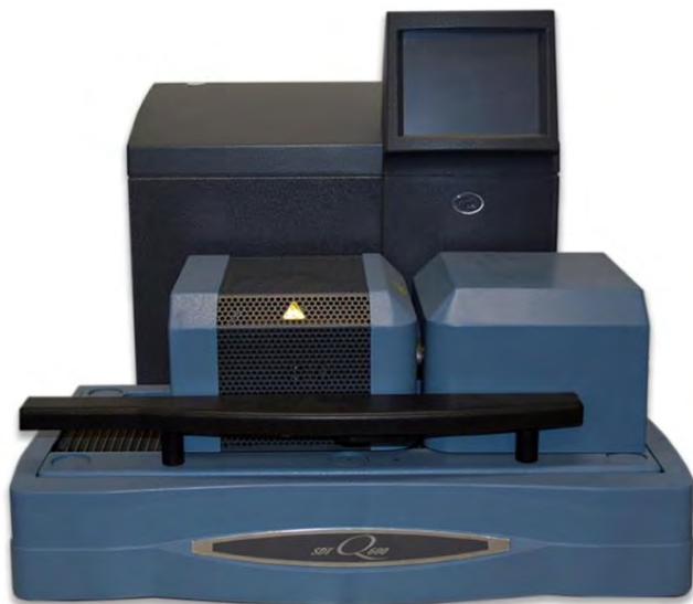
Figura 2.7 Calorímetro marca TA instruments, modelo Q600, con el cual se detectaron las diferentes transformaciones en las fases en función de la temperatura.
