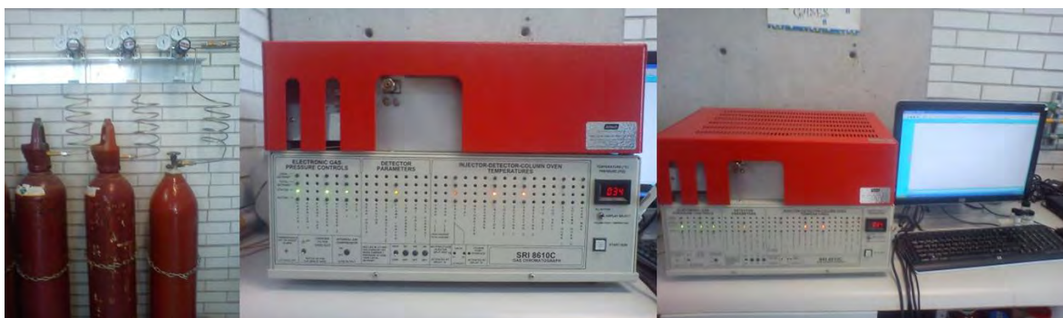
Figura 2.1. Cromatógrafo de gases Altech SRI8610C. Tanques de N 2 , H 2 y Aire a la izquierda; en el centro se encuentra el equipo y a la derecha el software.
