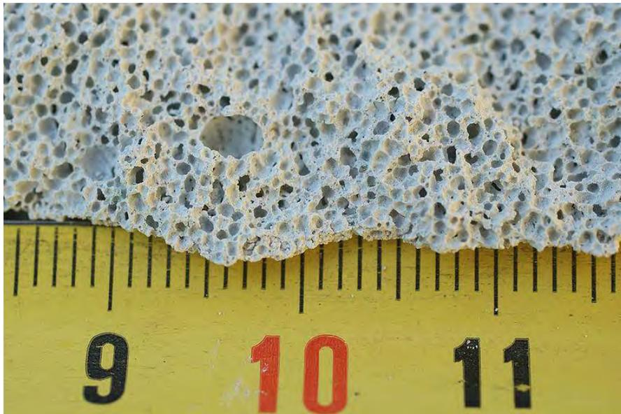
FIGURA 52. Detalle macro del hormigón celular curado en autoclave.
