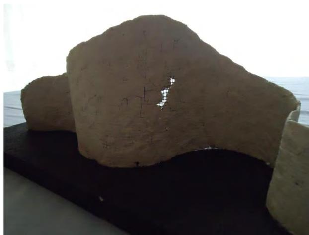
FIGURA 94. Modelo de la piel, donde se puede apreciar en un segmento la malla metálica.
