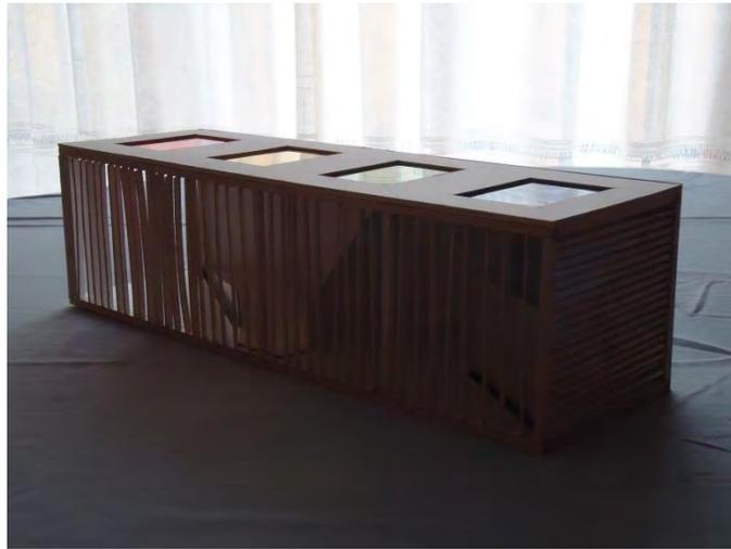
FIGURA 93. Modelo de la Iluminación, compuesto de madera, papel batería y papel celofán.
