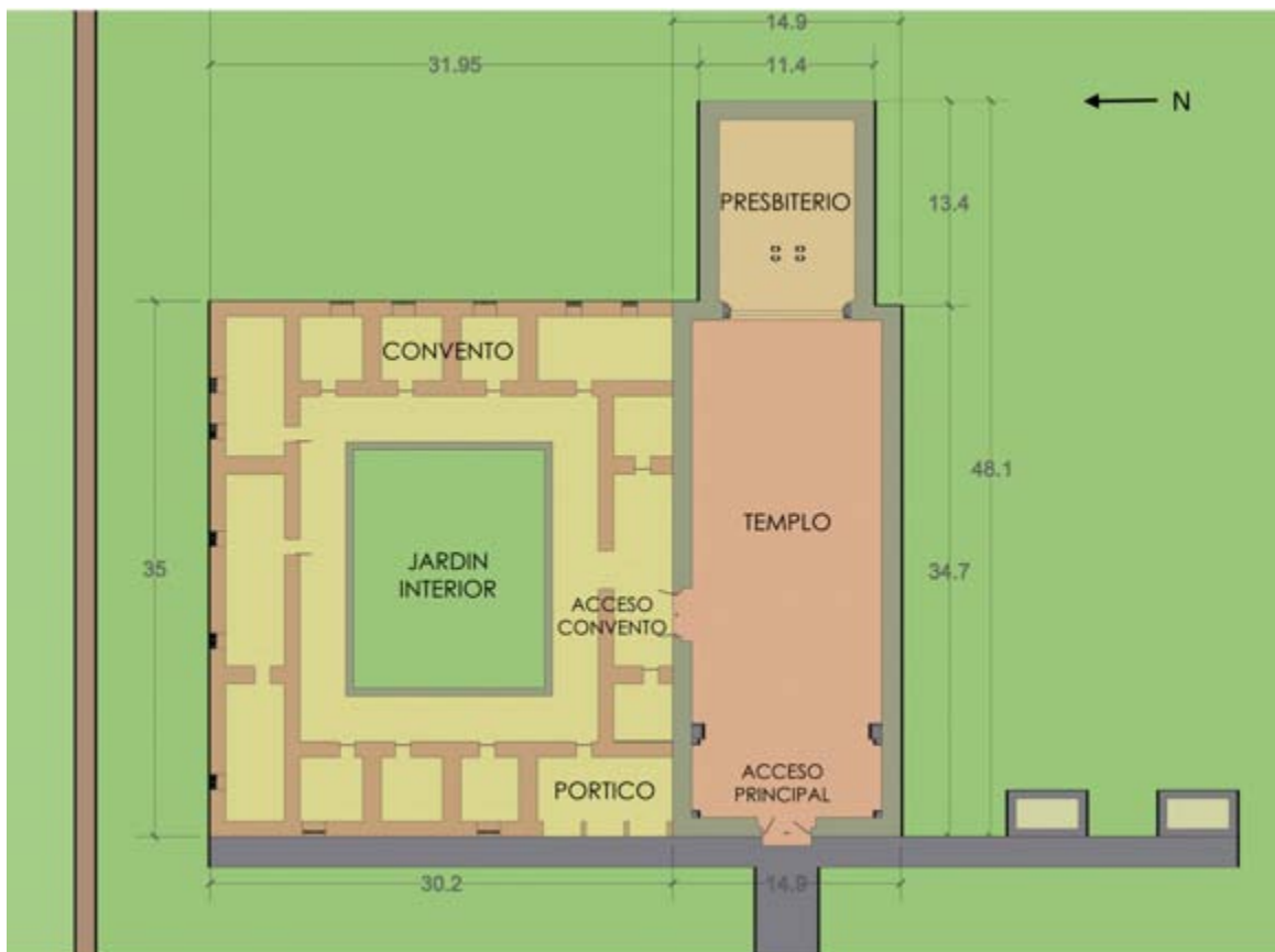
Fig. 22 Propuesta de la planta arquitectónica del conjunto conventual de Concepción de Nuestra Señora, Tehuacán.
