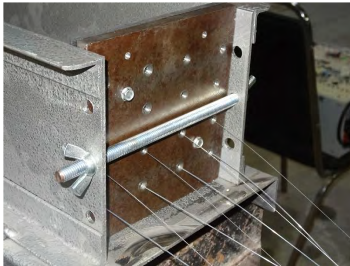
Figura 3.15. Ubicación de las Fibras Ópticas en el molde (Fotografía).
