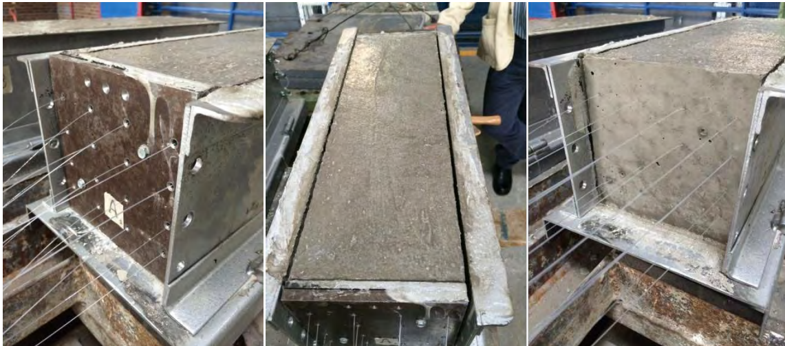
Figura 3.10. Secuencia del desmontaje del molde y placas laterales (Fotografía).
