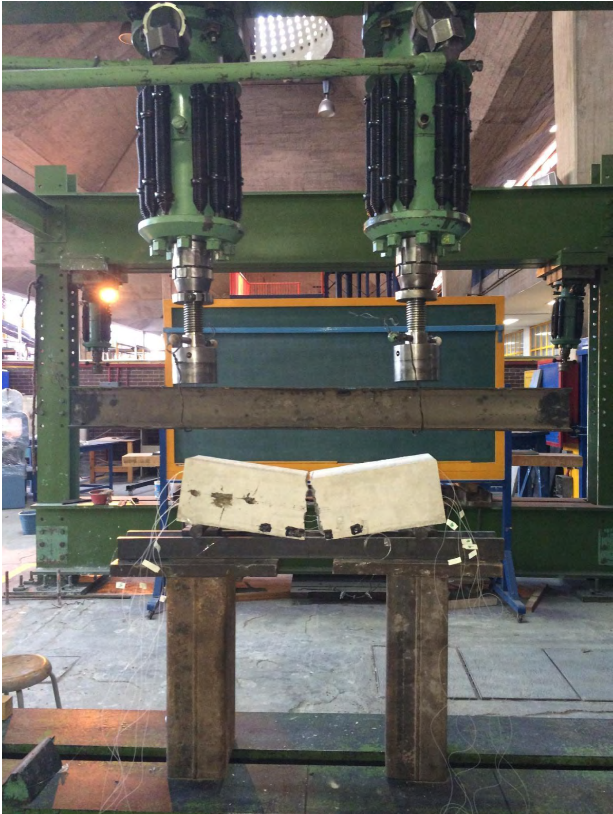
Figura 5.5. Viga de concreto con falla mecánica.
