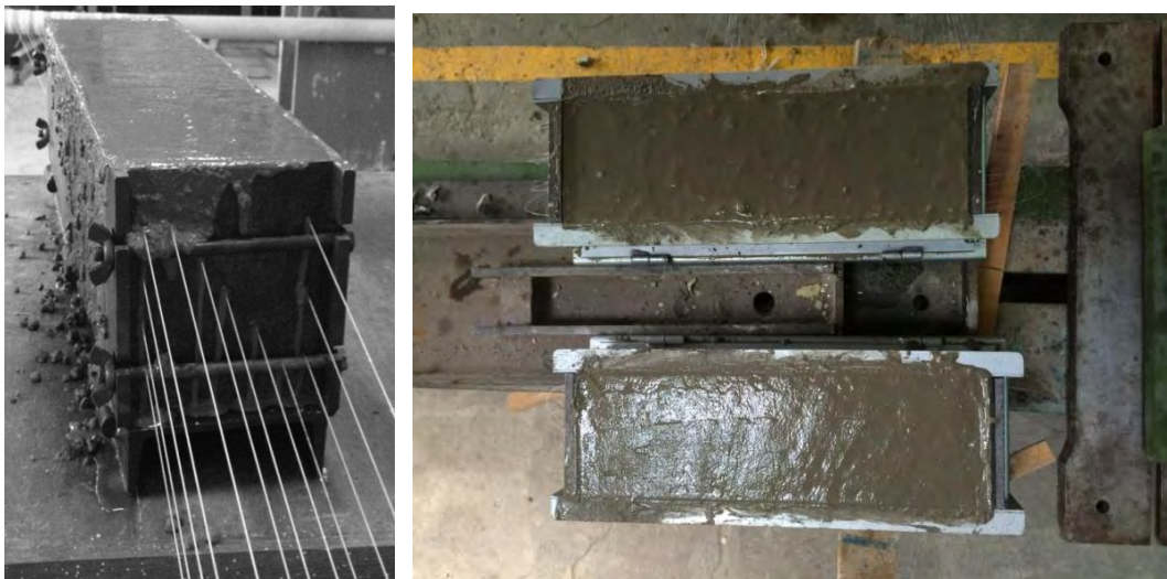
Figura 3.5. Tres Elementos Estructurales con fibras ópticas embebidas (Vigas #1, #2 y #3).
