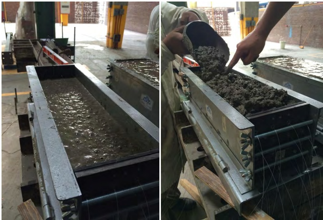
Figura 3.3. Fabricación y llenado del molde #3.
