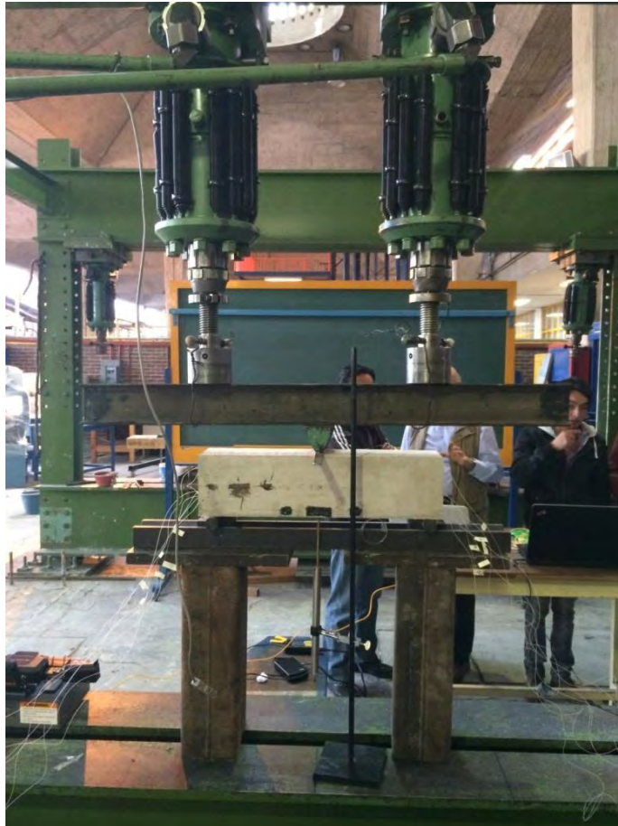
Figura 5.1. Arreglo del ensayo de elementos estructurales con fibras ópticas embebidas.
