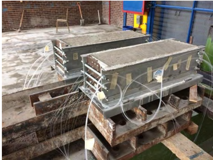
Figura 3.9. Elementos estructurales en los moldes después de 24 horas (Fotografía).
