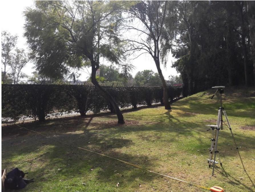
*Figura 5.8. Acomodo de sonómetros en Punto 2 a una distancia de 5 m
