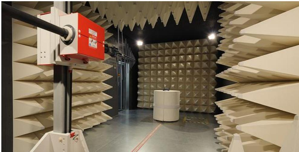
Figura 1.15 Cámara semi anecoica.
