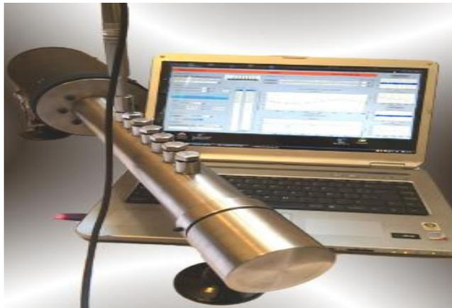
Figura 1.12. Tubo de impedancia
