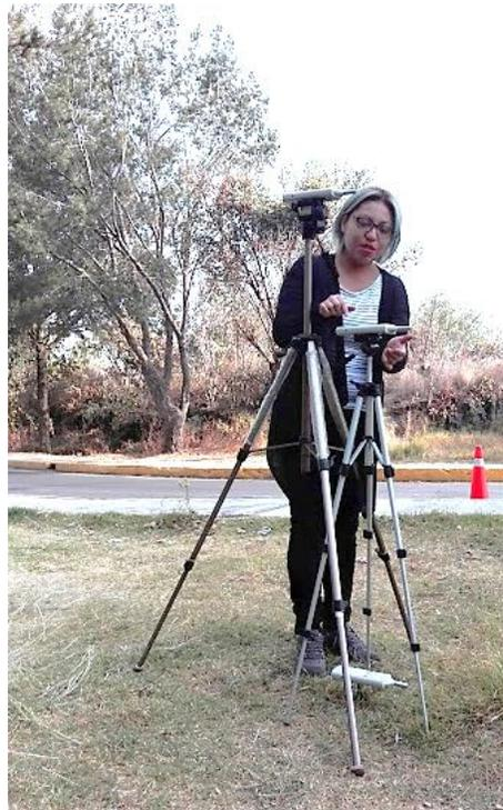
*Figura 5.10. Calibración de sonómetros
