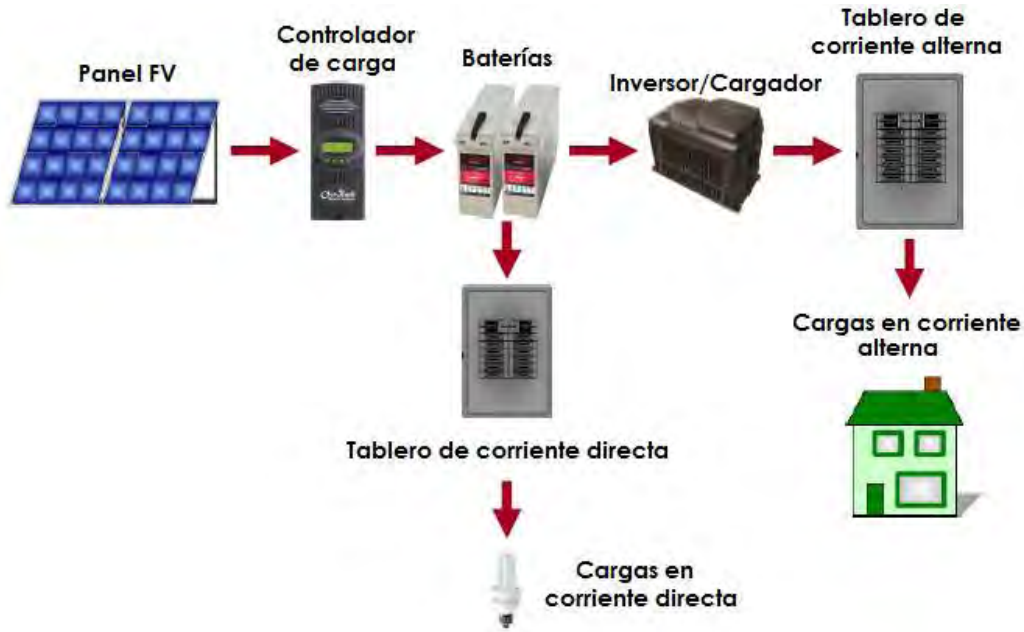
Figura 2.10. Diagrama esquemático de un sistema FV autónomo
