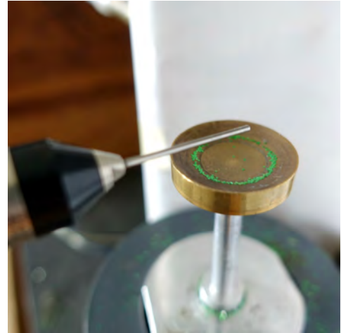
(b) Medición de la frecuencia de resonancia.
