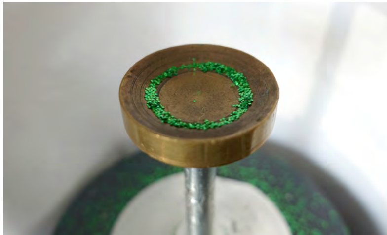
Figura 5.2: Disco vibrando en el primer modo de vibración. Las partículas de diamantina evidencian la presencia del anillo nodal en donde la amplitud de la vibración es casi cero.
