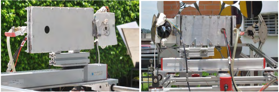
Figura 4.8. Instalación del receptor (Blanco Lambertiano) sobre el actuador lineal (izquierda), e instalación y conexión de mangueras en el receptor y radiómetro (derecha).
