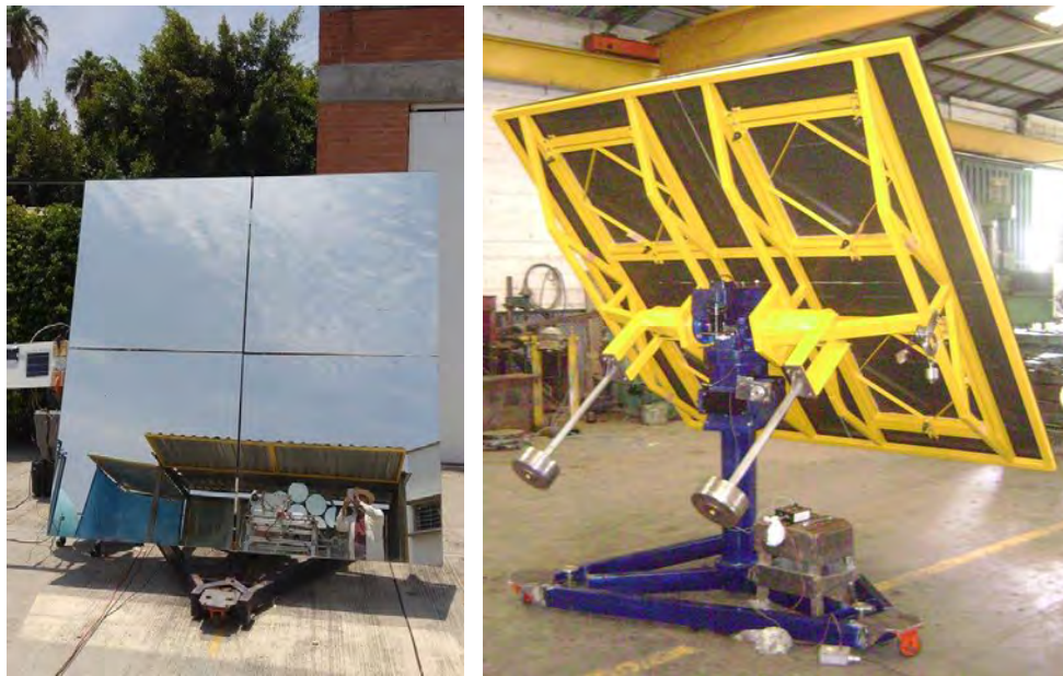
Figura 3.4. Mini Heliostato de 5.6 \text{ m}^2 en la plataforma del IER-UNAM (izquierda), estructura de soporte de las facetas del heliostato (derecha).
