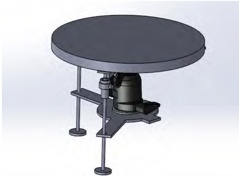
Figura 3.3. Esquema de diseño de los soportes de los espejos del concentrador y sistema de alineación manual mediante los tornillos sin fin.
