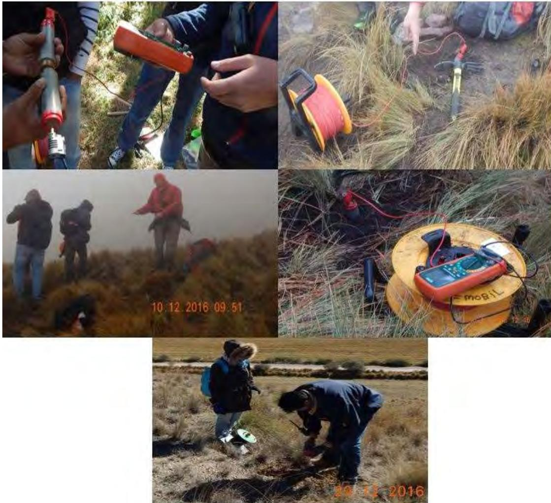
**Figura 5.2.** Trabajo de campo comienza con la estimación del offset, se elige un sitio con un potencial cero arbitrario, se realiza la medición cada 20m, y como control de calidad se mide la resistencia de contacto en (Ohm) y luego la medición de SP (en mV).
