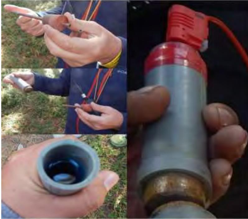
**Figura 5.1.** Esquema de los electrodos no polarizables tipo Cu/CuSO<sub>4</sub> ideales para emplear la técnica de SP.
