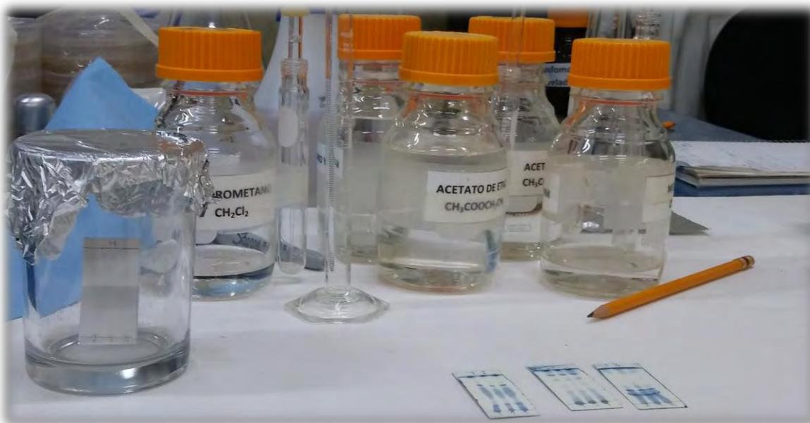
**Figura 11:** Cromatografía en capa fina para la selección del sistema de elución adecuado.
