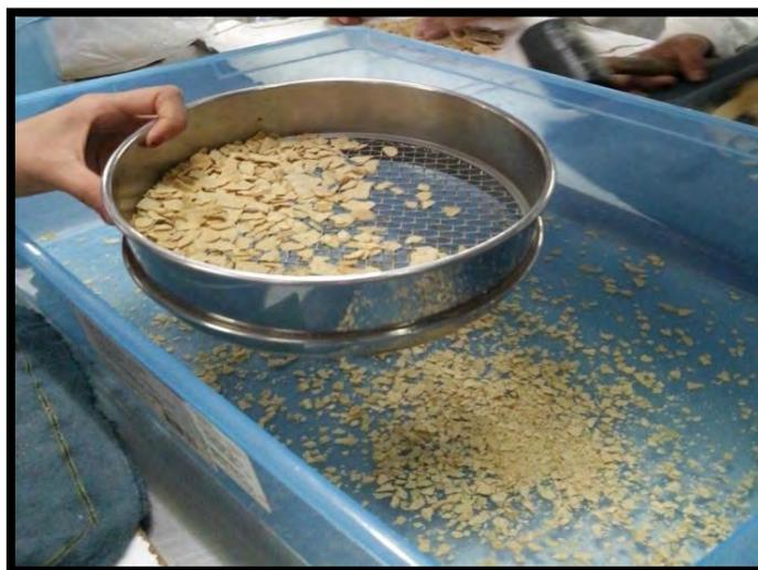
**Figura 2.2.** Determinación del tamaño inicial de partícula en tortilla de maíz endurecida
