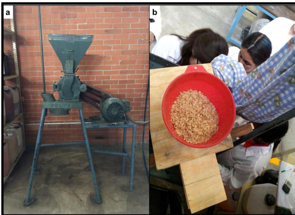
**Figura 2.3. Molienda de tortillas endurecidas; a) Molino Pulvex 200; b) Alimentación de tortillas endurecidas en el equipo**
