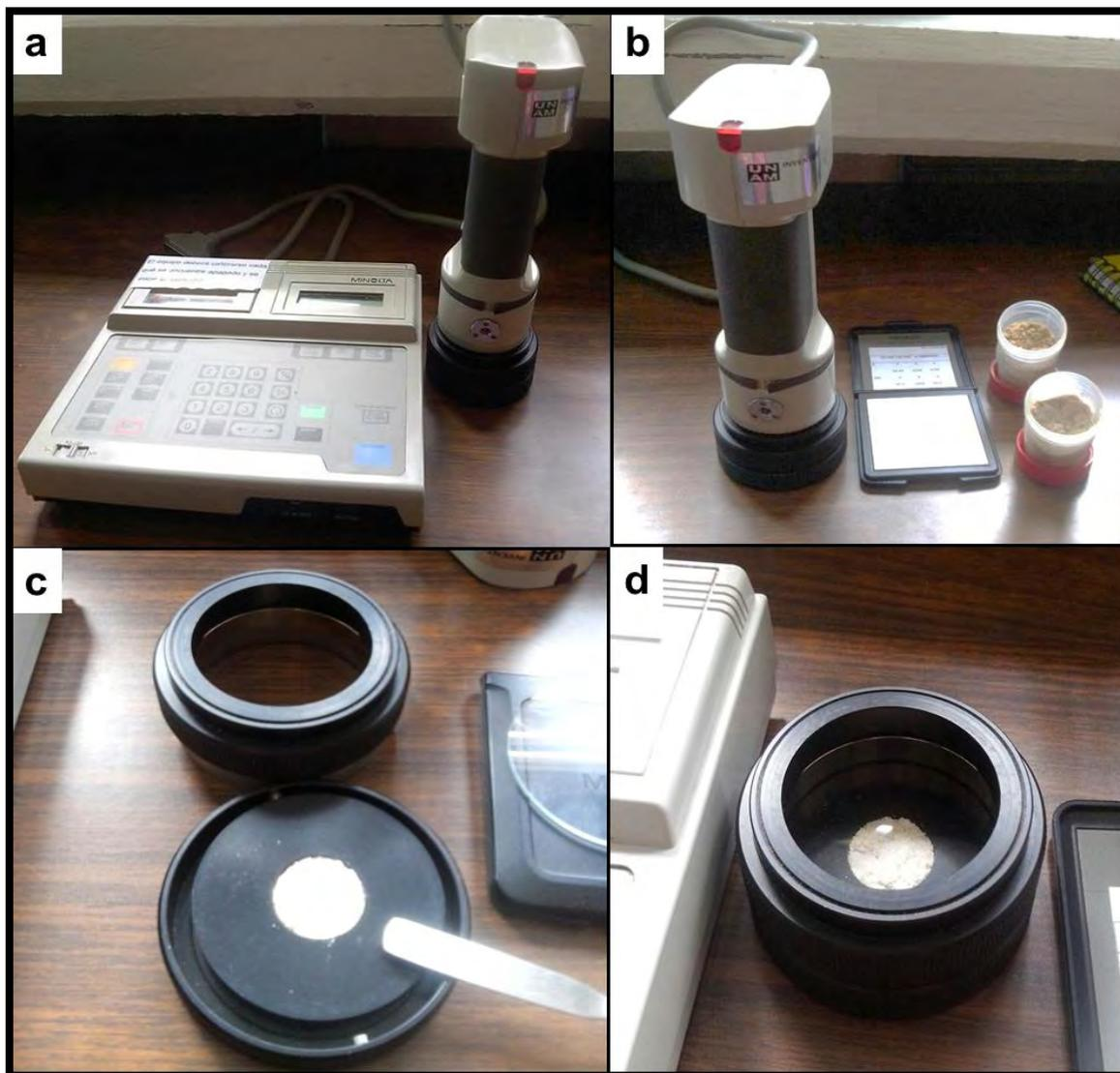
Figura 2.10. Determinación de color de harinas de maíz; a) Colorímetro Minolta Modelo CR300; b) Preparación de las muestras; c) Llenado con harina del dispositivo obscuro; d) Colocación del lente
