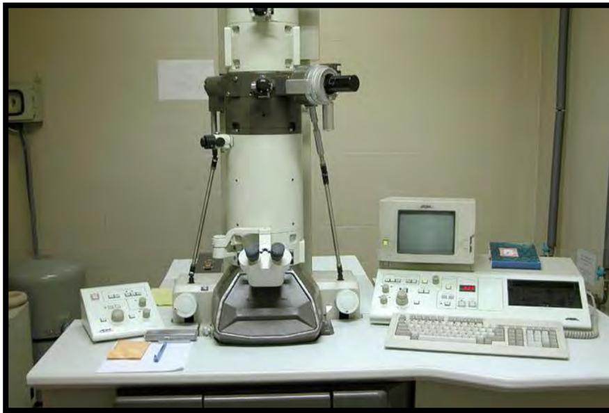
**Figura 1.20. Microscopio Electrónico de Barrido**
