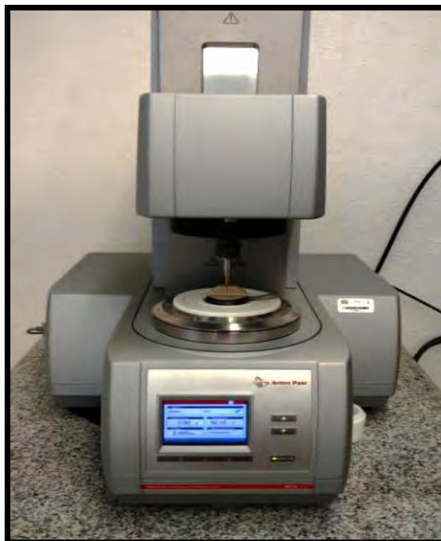
**Figura 2.8. Reómetro Anton Paar MCR 102 con celda de almidón**
