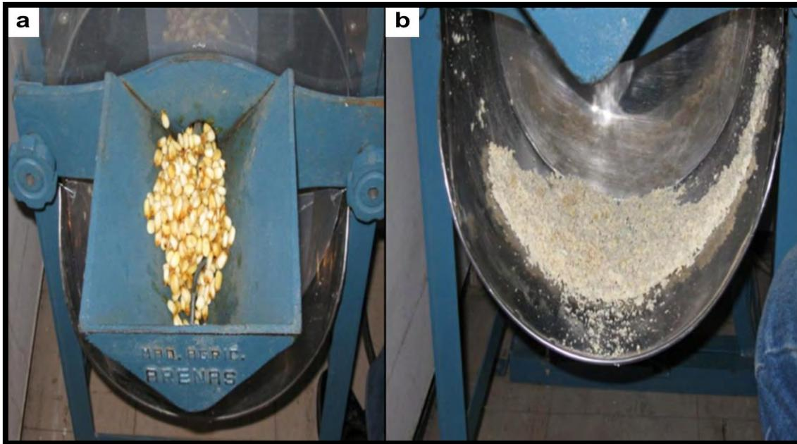
**Figura 1.5. Molienda de nixtamal; a) molino de discos piedras volcánicas, b) granulado húmedo masa.**
