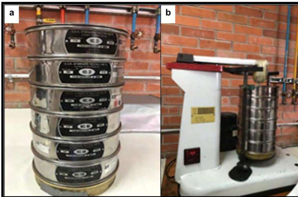
**Figura 2.5. Separación mecánica de las fracciones de tamaño de partícula en Ro-Tap; a) Tamices normalizados utilizados; b) Montaje de la serie de tamices en el equipo**
