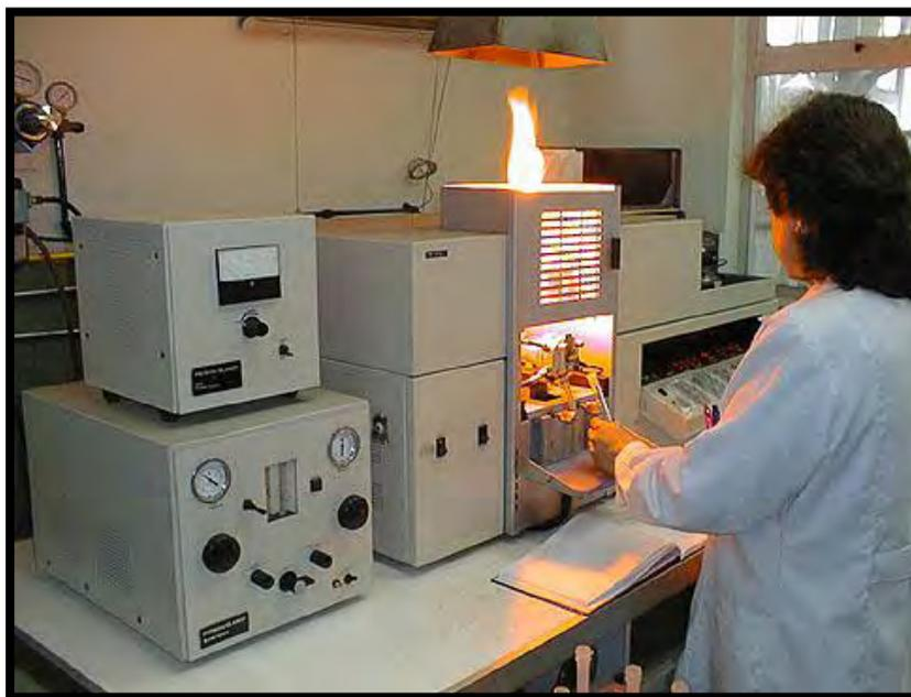
**Figura 1.19. Espectrofotómetro de absorción atómica**
