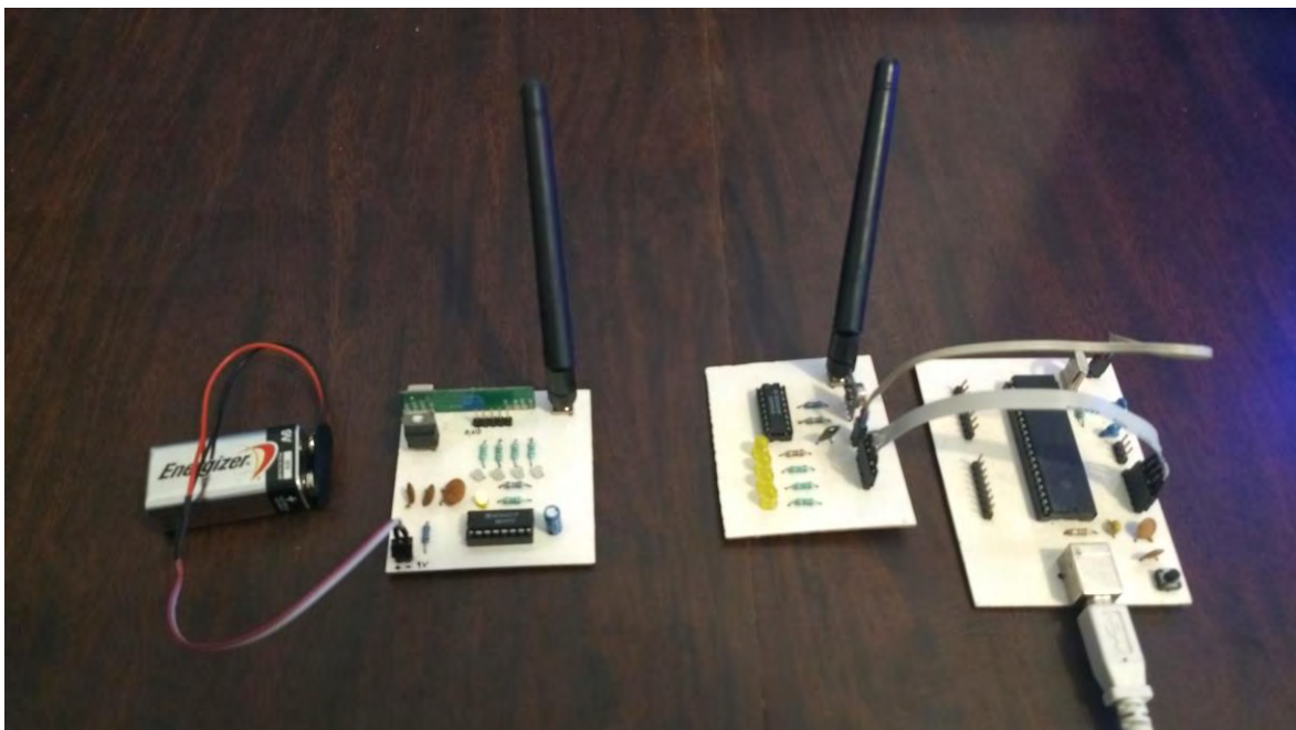
Figura 5.7.- Siempre y cuando haya enlace con el Tx se enciende el bit de estado VT.
