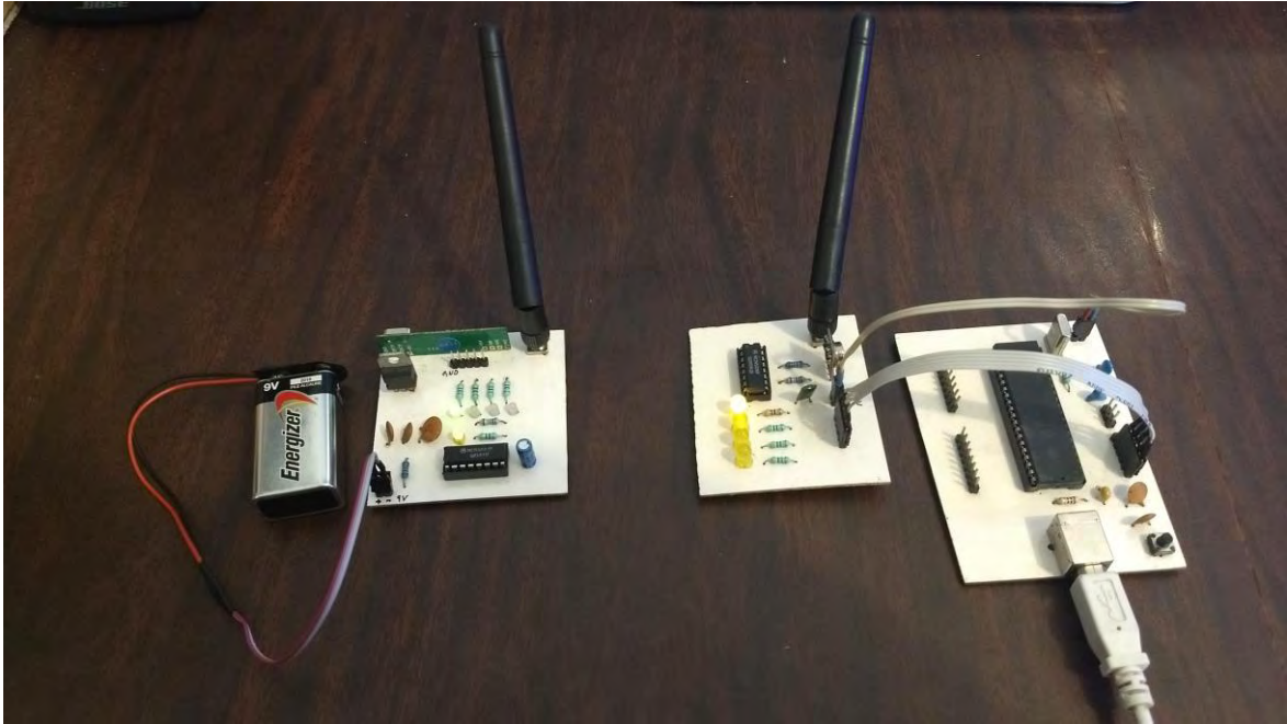
Figura 5.8.- Bit enviado por el Tx a través de la interfaz a la derecha de la foto y recibido por el Rx a la izquierda.
