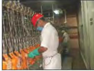
*Figura 6.* Proceso de eviscerado en una línea automática (FIRA, 2016).
