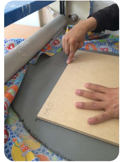
De izquierda a derecha. FIGURA 48. Preparación de laminadora para corte. FIGURA 49. Corte de pieza con molde de MDF. FIGURA 50. Retiro de exceso de pasta en la pieza. Fuente: Colección propia.
