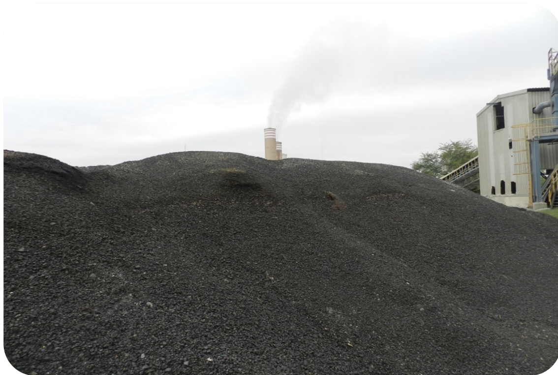
FIGURA 06. Patio de almacenamiento de ceniza volante en Central Termoeléctrica “Presidente Plutarco Elías Calles”, Petacalco. Gro. 2016. Fuente: Colección propia
