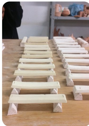
De izquierda a derecha. FIGURA 35. Triangulo triaxial con piezas de ambas pruebas posterior a la quema de media temperatura, previas a someterlas a pruebas mecánicas. FIGURA 36. Piezas de ambas pruebas determinando la flexión final. Fuente: Colección propia.
