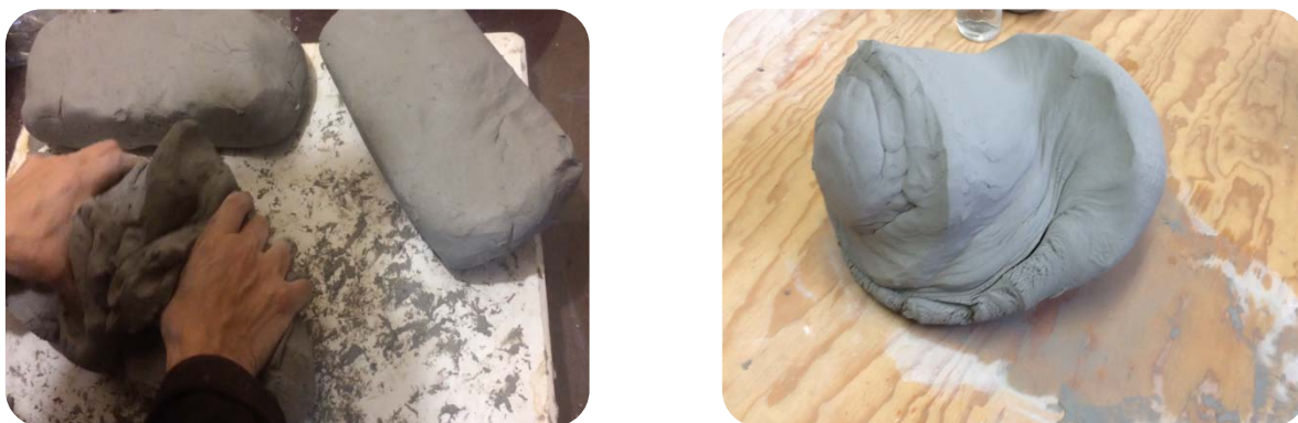
De izquierda a derecha. FIGURA 46. Pasta deshidratada en bloques y previa a añejamiento. FIGURA 47. Pasta posterior al añejamiento y perfectamente amasada. Fuente: Colección propia.
