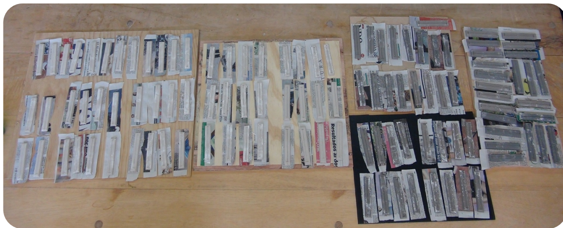
FIGURA 34. Termino de la fabricación de las 112 piezas de ambas pruebas previas a quema de media (1100°) y alta temperatura (1250°). Fuente: Colección propia.
