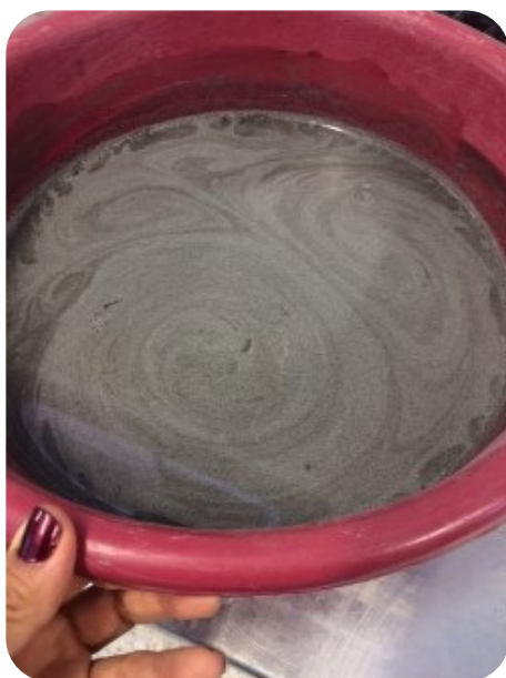
De izquierda a derecha. FIGURA 23 y 24. Ceniza tamizada en una malla de 100u. y retiro de residuos ajenos a la CV. Fuente: Colección propia.
