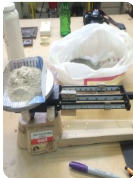
De izquierda a derecha. FIGURA 26 y 27. Medición y pesaje de los elementos en balanza granataria para ambas pruebas. Fuente: Colección propia.
