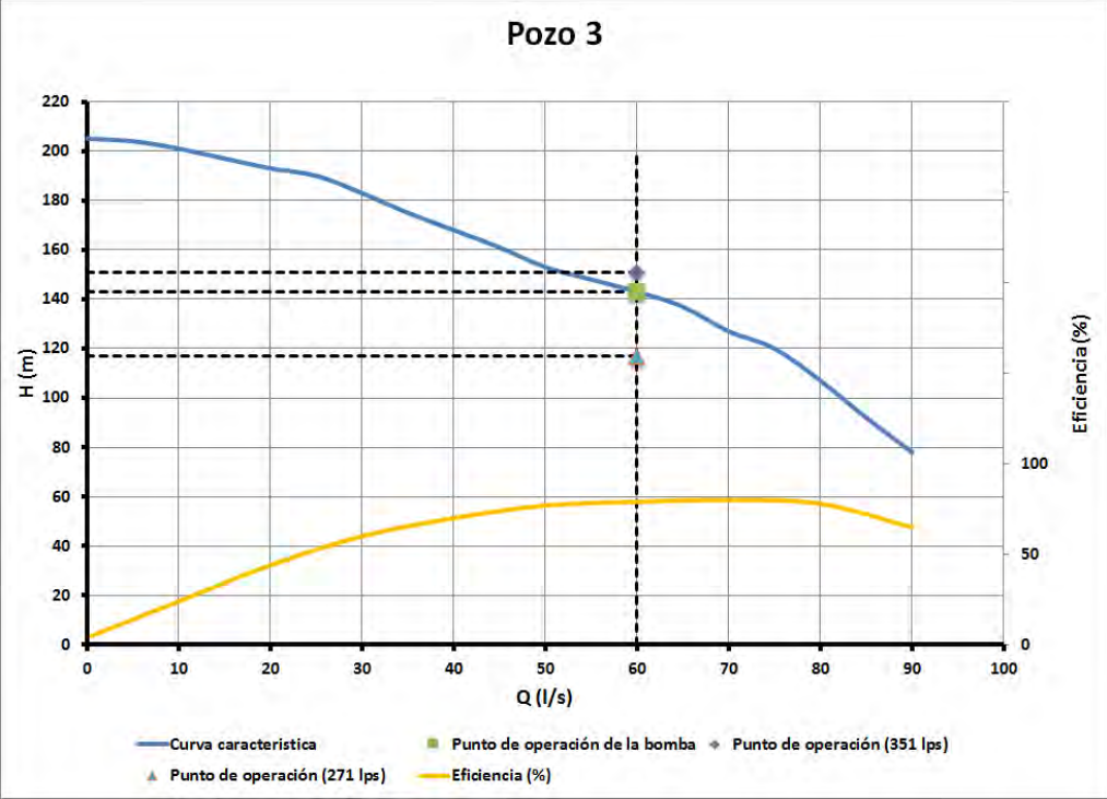
Figura 5.4. 5 Carga de bombeo 351 l/s y 271 l/s (Pozo 3)
