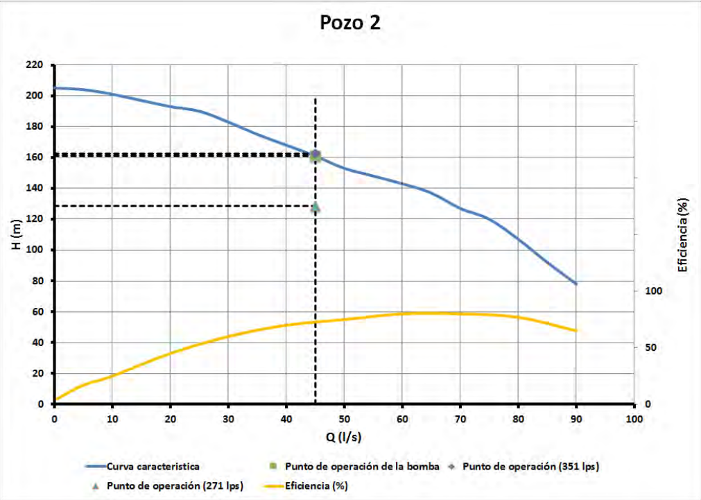
Figura 5.4. 2 Carga de bombeo 351 l/s y 271 l/s (Pozo 2)
