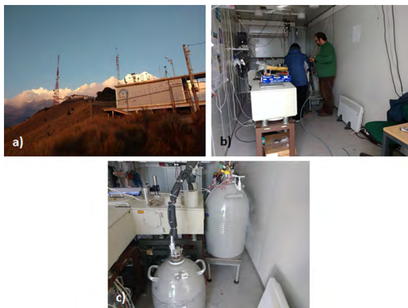
Figura 2.2: a) Observatorio atmosférico Altzomoni. b) Espectroscopio Bruker 120/5 HR. c) Sistema de enfriamiento por nitrógeno líquido.
