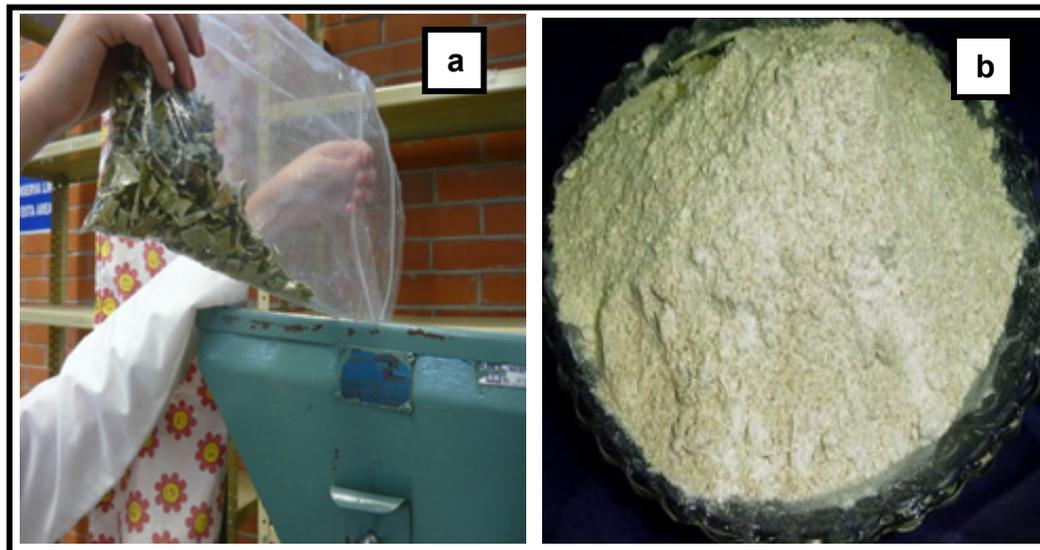
**Figura 2.9 Molienda de nopal a) Pulvex 200, b) Sólidos granulares de nopal**
