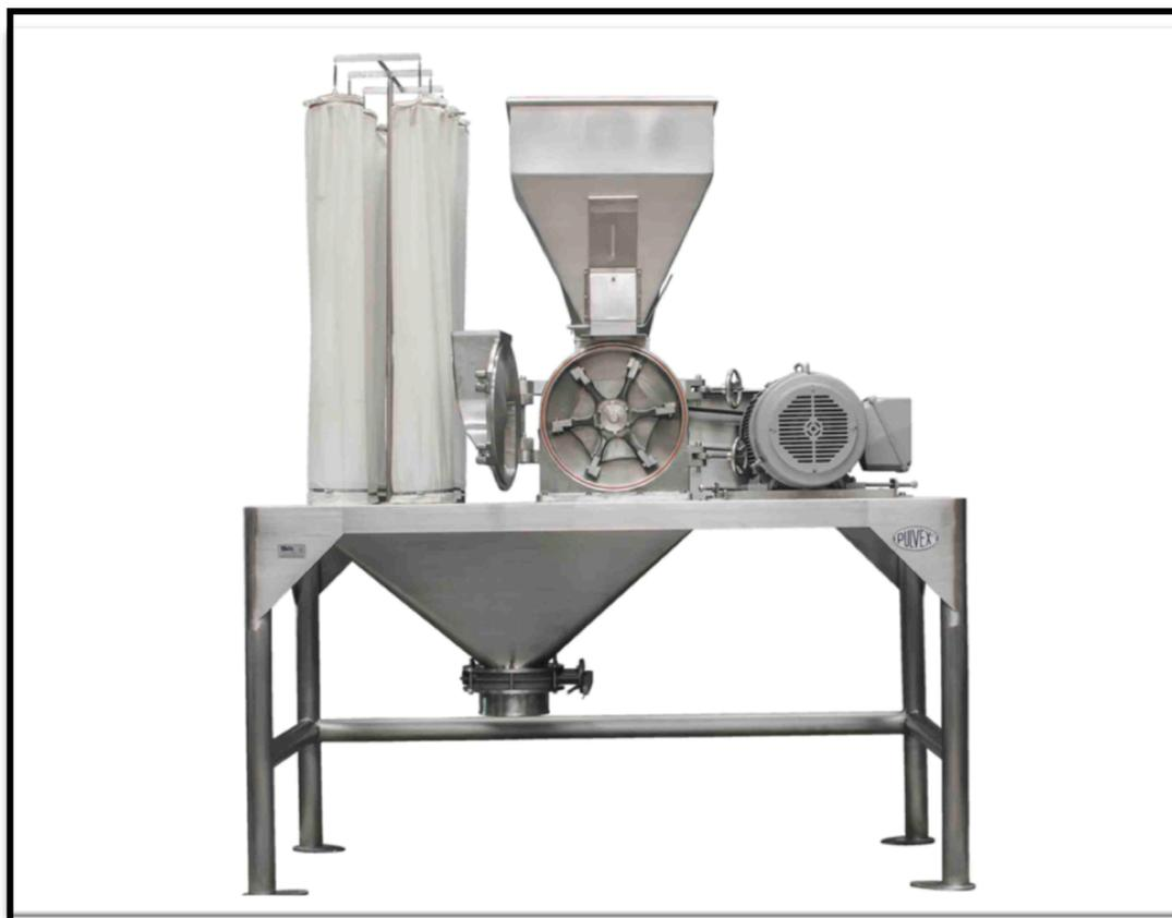
**Figura 1.7 Molino Pulverizador de turbina**
