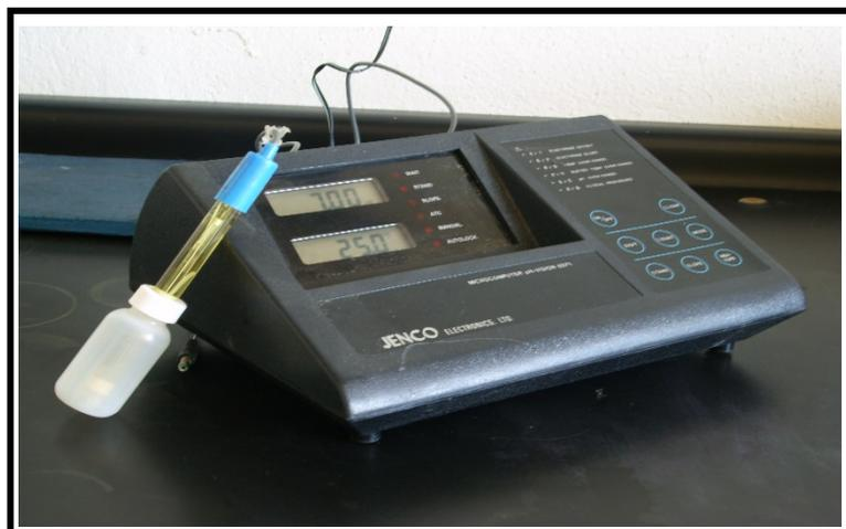
**Figura 1.12 Equipo para determinar el pH**
