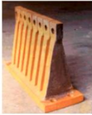
Figura 2.5 Disipador tipo TADAS (Oviedo, 2006)
