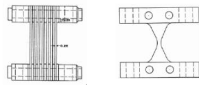
Figura 2.4 Disipador tipo ADAS (Oviedo 2006)
