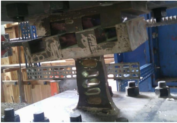
Figura 4.4 Daños en disipadores tipo 1
