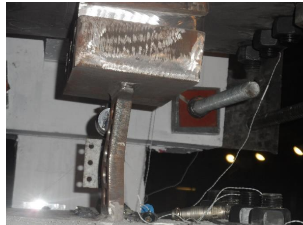
Figura 4.5 Daños en disipadores tipo 2
