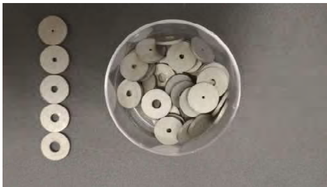
Figura 3.4: Set de colimadores de diferente diámetro (desde 1 mm a 5 mm de diámetro).
