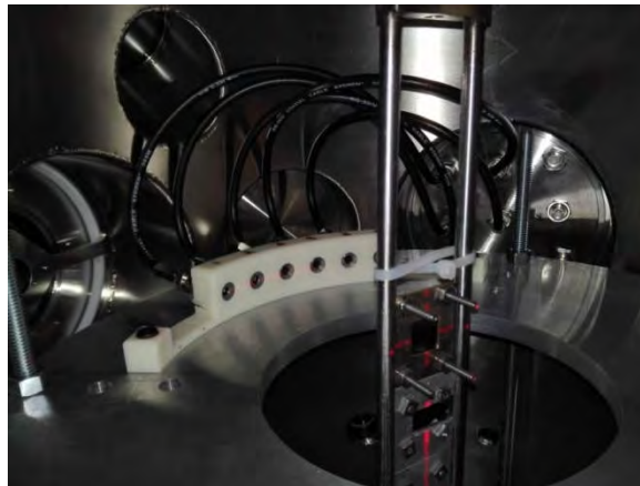
Figura 3.2: Arreglo de detectores PIPS (PIDAR) en su montura dentro de la cámara de dispersión.
