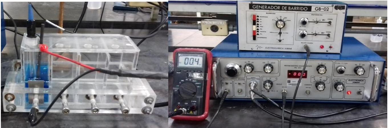
Figura 41. Sistema electroquímico (celda, generador de barrido y potenciostato galvanostato) utilizado para obtener curvas de polarización.
