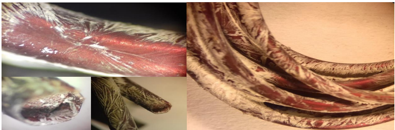
Figura 39. Alambre de cobre recubierto con barniz al término de la experimentación en el reactor.
