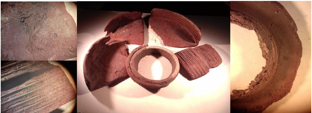
Figura 38. Bronce al término de la experimentación en el reactor.
