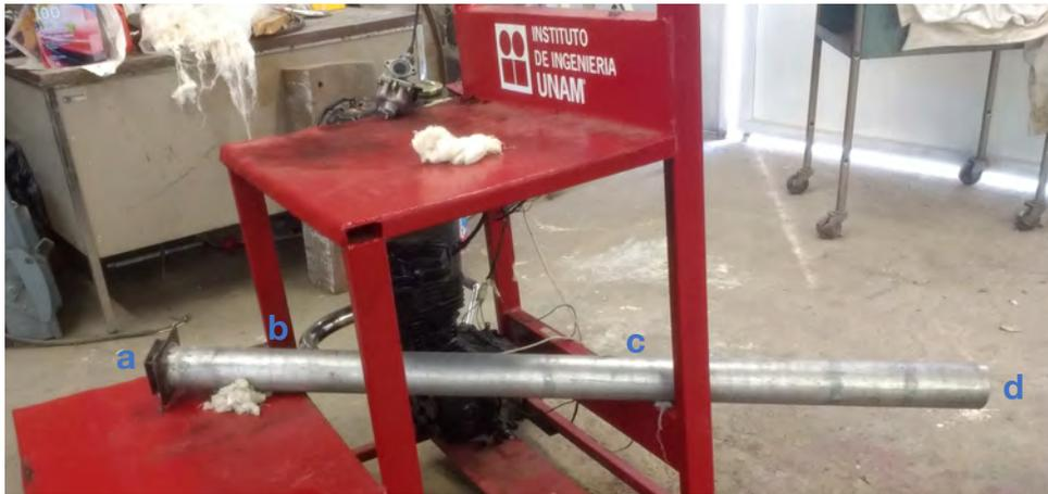
**Figura 3.5:** Sistema de muestreo de volumen constante: (a) ventilador (b) conexión con el escape del motor (c) túnel de mezclado (d) puerto de muestreo.
