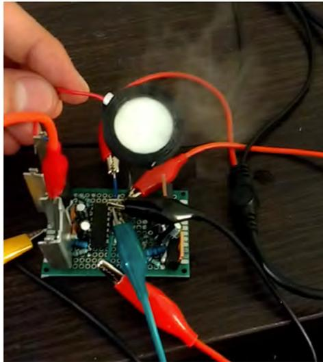
**Figura A.3:** Medio amplificador clase D operando el cristal de 1.7 MHz.
