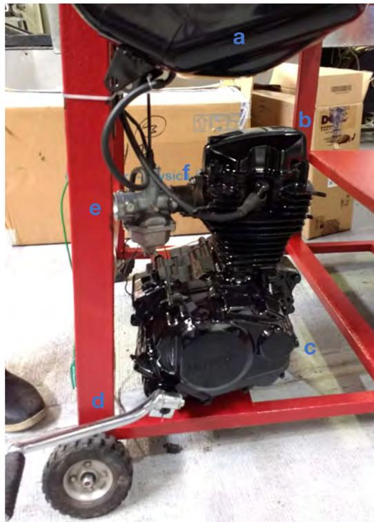
**Figura 3.1:** Motor sin el escape montado en el banco de pruebas: (a) tanque de combustible (b) culata (c) cárter (d) pedal de arranque (e) carburador (f) colector de admisión.
