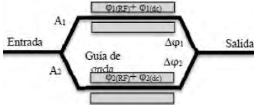
Fig. 1.1 Modulador óptico diferencial de doble brazo Mach – Zehnder [5]
