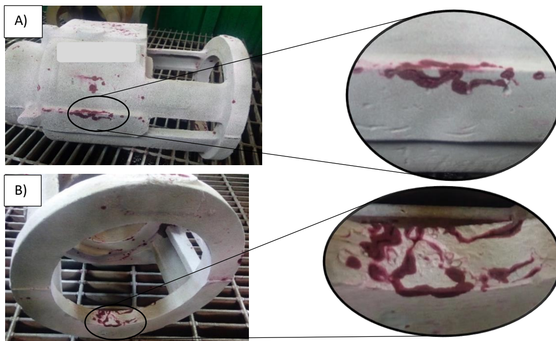
Figura 52. Zonas de pliegues: A) del lado contrario al sistema de colada y B) sobre la corona.
