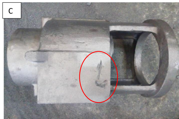
Figura 50. Evidencia de cavidades atrapamiento de inclusiones no metálicas (A) y por material frío (B y C).
