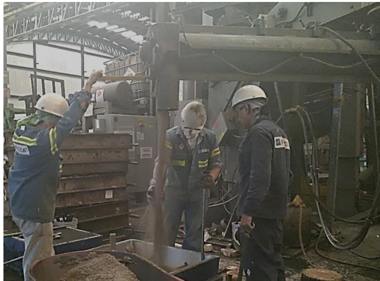
Figura 1. Tolva de suministro de mezcla de arena en el proceso autofraguante
