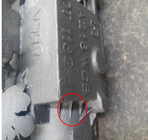
Figura 49. Pliegues superficiales, causados por material frío.
