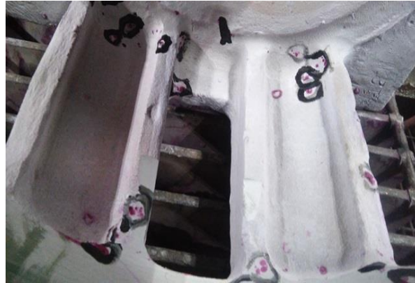
Figura 33. Fotografías de líquidos penetrantes que revelan el daño causado por arrastre de arena a lo largo de la superficie.
