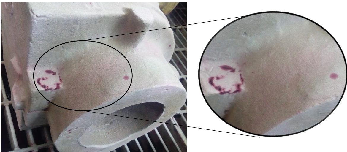
Figura 57. Pliegue y porosidad en la parte trasera de la pieza.
