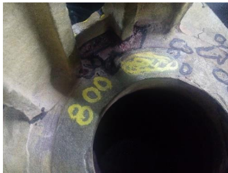
Figura 62. Identificación de rechupe interno de difícil acceso.
