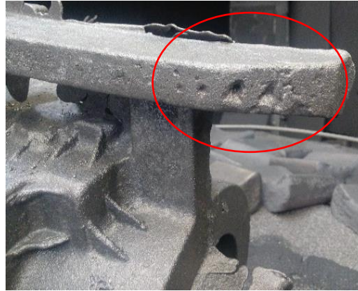
Figura 51. Atrapamiento de inclusiones en los corredores.
