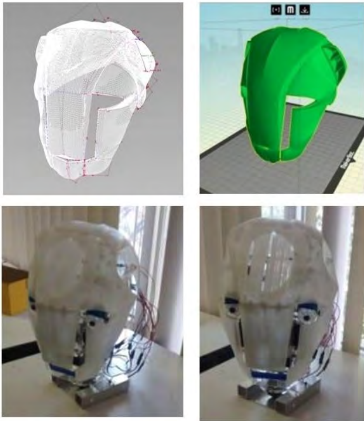
Figura A.5: Fabricación del modelo físico en impresión tridimensional.
