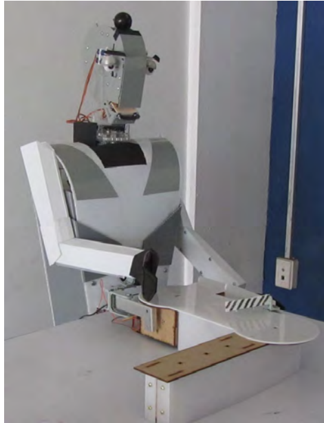
Figura 6.1: Prototipo facial GolemX-1 con torso, mano móvil e interfaz de colaboración
