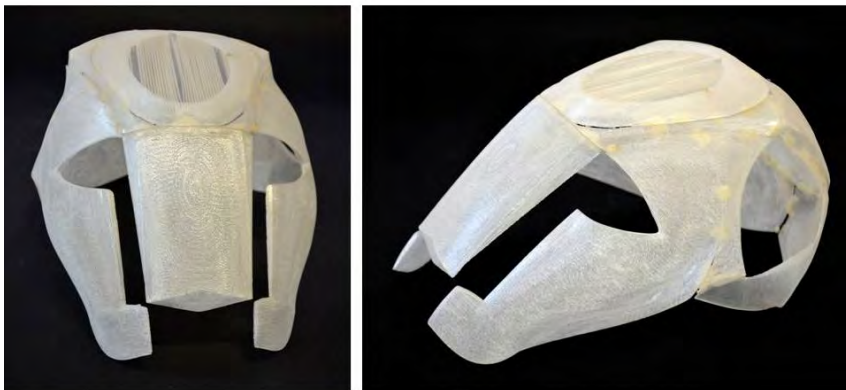
Figura A.6: Cubierta fabricada con impresión tridimensional.
