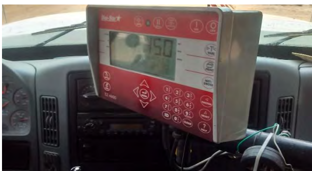
Figura 7.- Sistema de alimentación automático, con pantallas al interior de los vehículos conectadas a la báscula del transporte.
