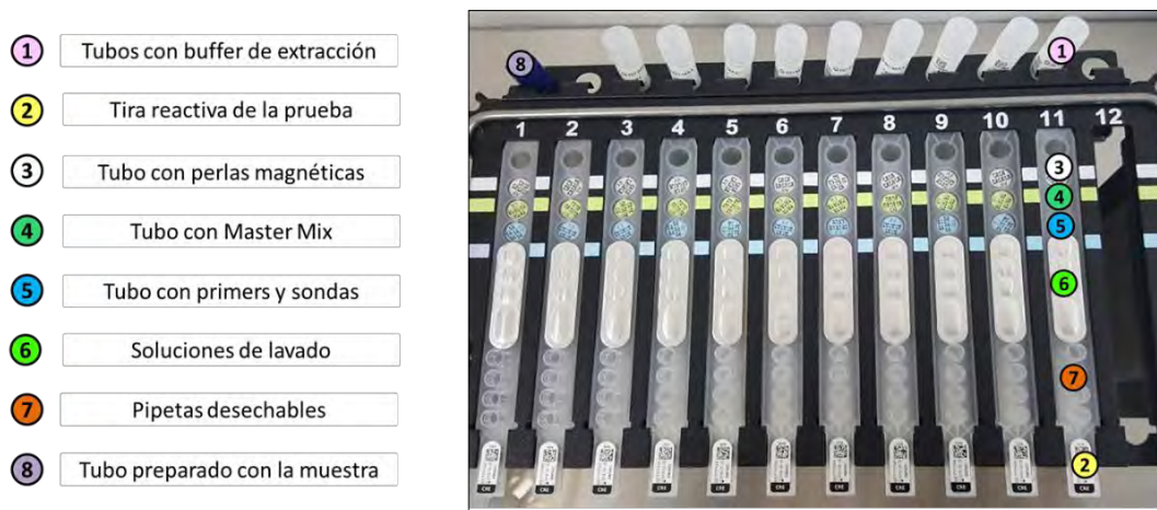
Figura 23. Algoritmo de la prueba de la reacción en cadena de la polimerasa para la detección de enterobacterias productoras de carbapenemasas.
