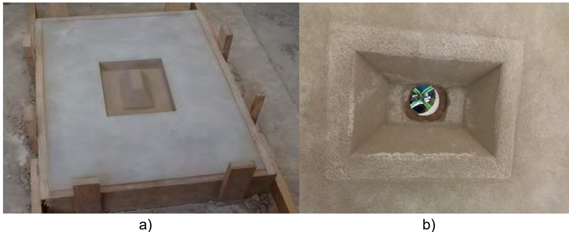
Figura 3.12. Vistas del molde para la placa modelo: a) parte inferior de la línea de partición b) parte superior de la línea de partición.
