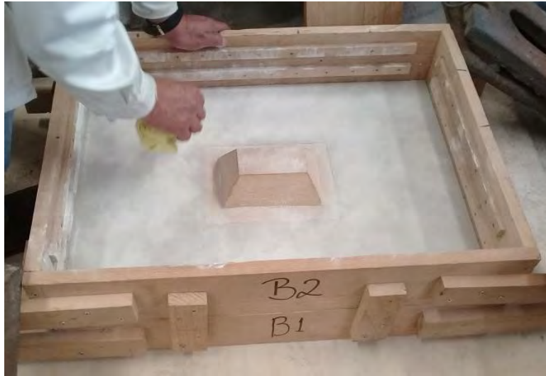
Figura 3.11. Proceso de moldeo para la realización de la placa modelo.
