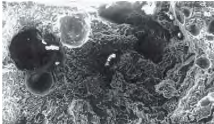
Figura 2.5 Imagen SEM de la porosidad por hidrógeno.
