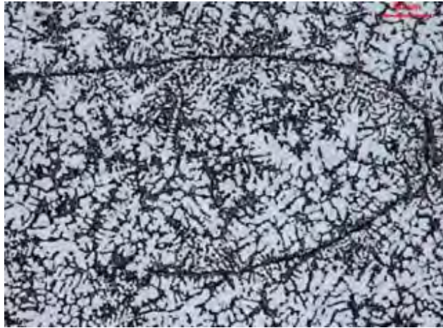
Figura 2.11 Micrografía de una doble capa de óxido.
