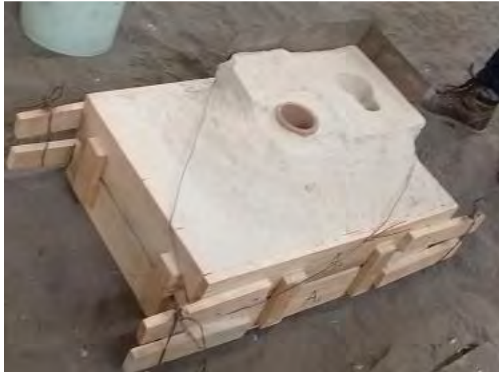
Figura 3.13. Molde terminado para la fabricación de la placa modelo.
