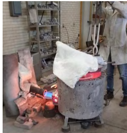
Figura 3.30. Horno de crisol a base de gas L.P.
