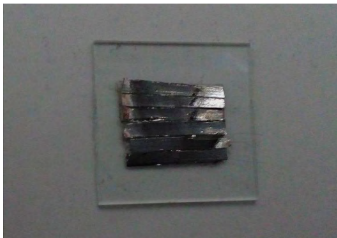
Figura 20. Portamuestras con la cinta vítrea preparada para análisis por (DRX).
