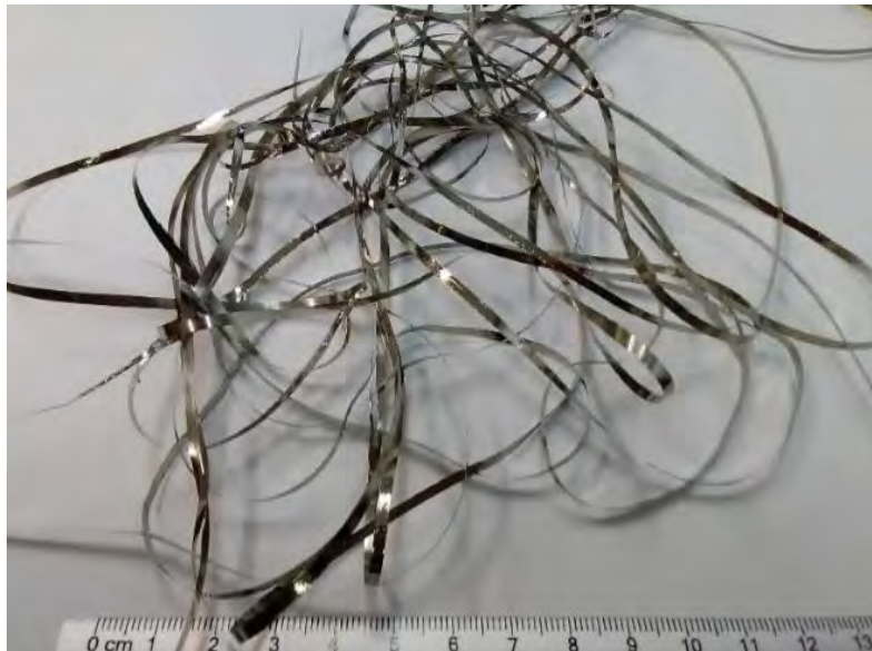
Figura 24. Aleaciones vítreas obtenidas en forma de cintas por el método de fusión "Melt-Spinning".
