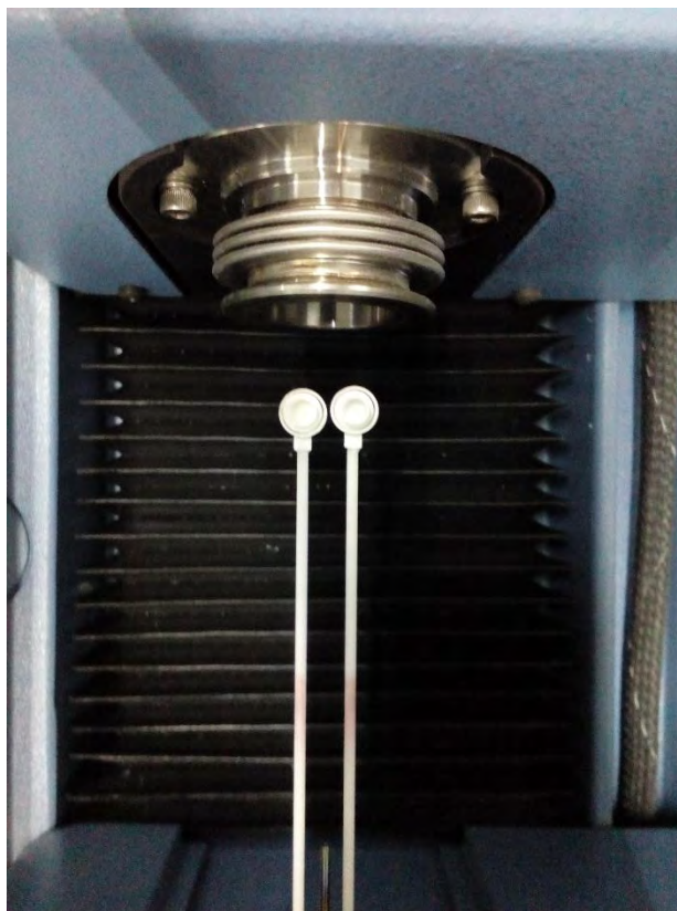
Figura 21. Cámara interna del horno de CDB. En la parte central se encuentran los dos crisoles de alúmina sujetos a dos termopares.
