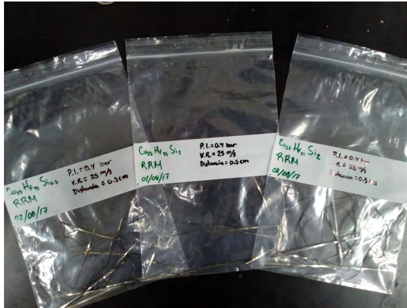
Figura 18. Cintas vitreas obtenidas por el "Melt Spinning", y etiquetadas en bolsas.
