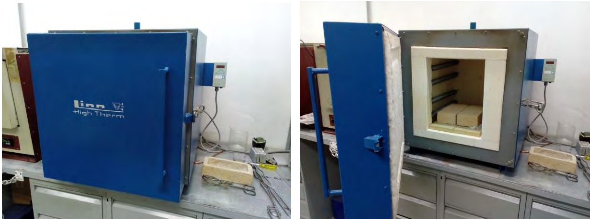
Figura 23. Horno marca Bentrup, modelo TC 40, vista externa (imagen derecha), vista interna (imagen izquierda). Utilizado para el tratamiento térmico de las cintas vítreas.
