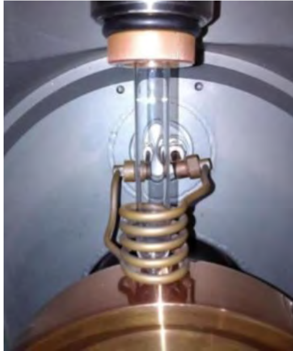
Figura 17. Crisol de cuarzo ensamblado en la cámara interna del “Melt-Spinning” para la fusión. El lingote se encuentra en la parte inferior del crisol y a la altura de la bobina de cobre.
