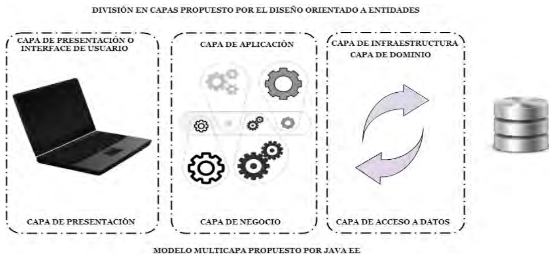
Figura 6. 1. Comparativa entre modelo multicapa propuesto por Java EE y modelo multicapa propuesto por el diseño orientado a entidades.
