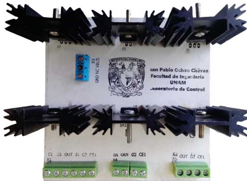
Figura 3.3. Pequeño inversor trifásico de tecnología IGBT4
