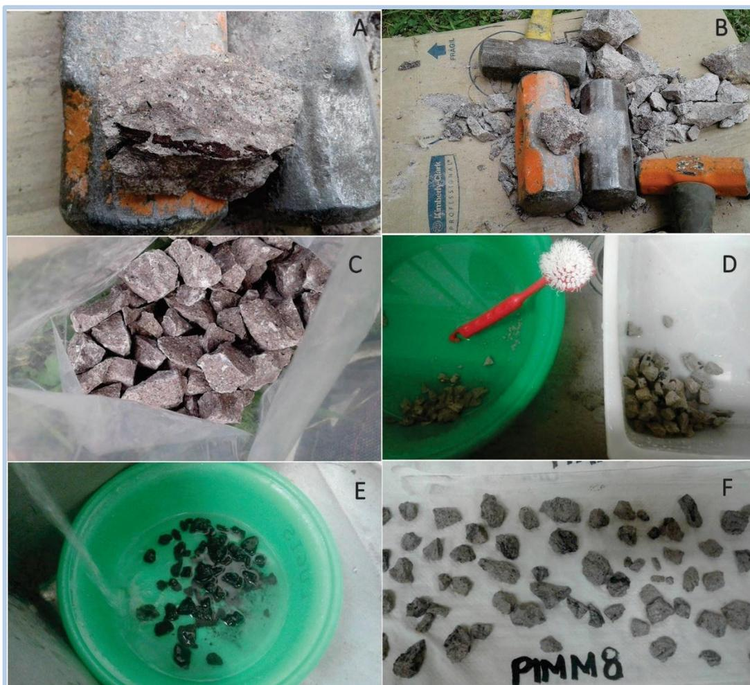
Figura 3.2. Preparación de las muestras para pulverizar. A) Muestra descostrada y representat para elaboración de lámina delgada; B) Descostrado de las partes intemperizadas; Fragmentos de roca de entre 2 y 5 cm de cada muestra; D), E) y F) Proceso de lavado con agua desionizada de los pedazos o fragmentos de roca para su posterior pulverización.
