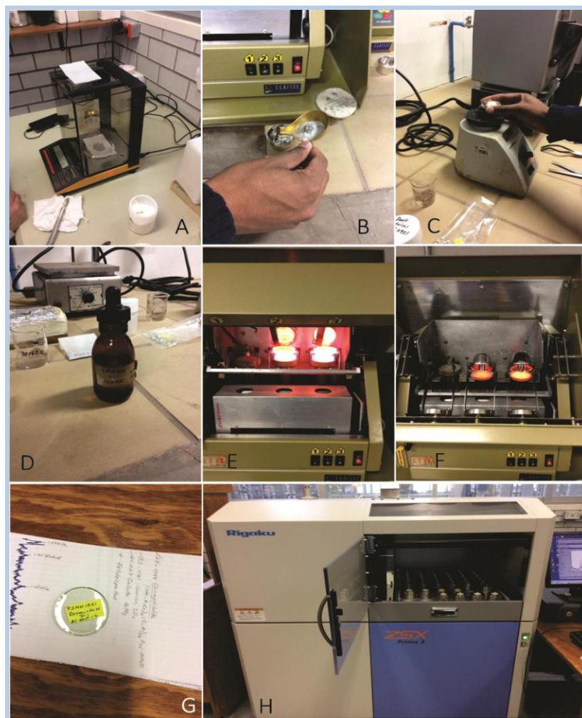
Figura 3.4. A) Pesado de compuesto fundente (8 gr) y muestra (0.4gr) en la balanza de precisión. B) Colocación de mezcla (fundente y muestra) dentro de un crisol de platino. C) Homogenización de la mezcla utilizando un vórtex. D) Incorporación de yoduro de litio a la muestra. E) Muestra caliente (1,000°C) en el hornillo. F) Obtención de la perla. G) Perla lista para medir en el espectrómetro. H) Espectrómetro secuencial de rayos X (Rigaku Primus II).
