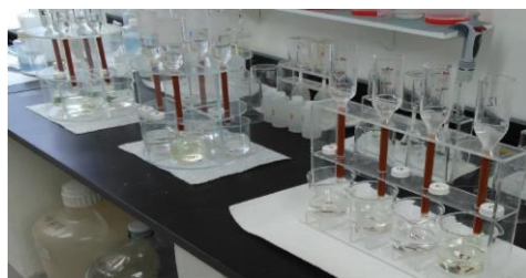
Figura 3.8 A) Columnas de intercambio iónico permanentes, utilizadas para la separación del Sr y las REE. B) Vasos de Teflón de 2 mL de una solución con el Sr, siendo sometidas a luz infrarroja para poder ser cargadas en el espectrómetro de masas.
