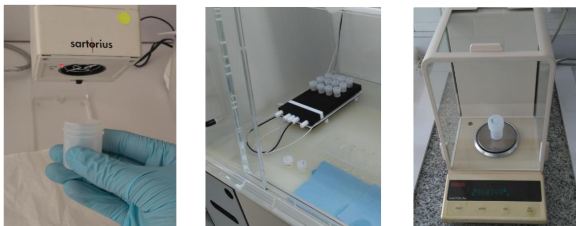
Figura 3.7 A) Ventilador de antiestática que impide que la muestras se quede pegada en las paredes de las bombas. B) Pesaje de las bombas para obtener el peso de las muestras de polvo antes de comenzar con el proceso de digestión C) Calentamiento de las muestras en una parrilla para realizar el proceso de lixiviado.
