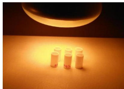
Figura 3.8 A) Columnas de intercambio iónico permanentes, utilizadas para la separación del Sr y las REE. B) Vasos de Teflón de 2 mL de una solución con el Sr, siendo sometidas a luz infrarroja para poder ser cargadas en el espectrómetro de masas.
