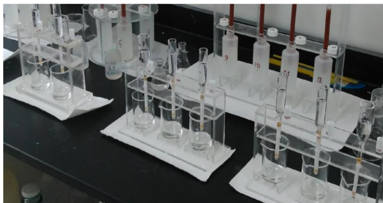
Figura 3.9 Columnas de intercambio iónico permanentes, utilizadas para la separación del Nd.
