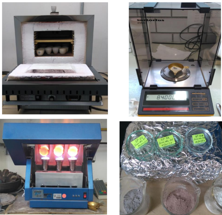
Figura 3.5 A) Mufla de calentamiento donde se introducen las muestras de roca para calcular el porcentaje de pérdida por calcinación. B) Pesaje del fundente con la muestra, deben ser proporciones exactas para que se obtengan resultados confiables. C) Proceso de fundición de la muestra. D) Perlas resultantes de la fundición de las muestras para ser medidas en el Espectrómetro de Rayos X.
