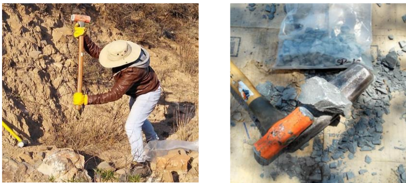
Figura 3.1 A) Se muestra el proceso de extracción de una muestra en campo para su posterior análisis en gabinete. B) Proceso de trituración de una muestra de roca para la elaboración de los análisis geoquímicos.
