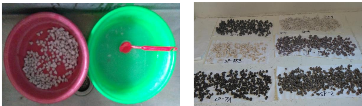
Figura 3.2 A) Proceso de lavado de las rocas para eliminar cualquier rastro de mugre y suciedad. B) Fragmentos ya lavados y en proceso de secado para su posterior pulverización.
