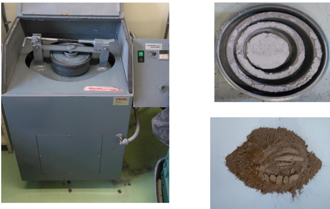
Figura 3.3 A) Mortero mecánico marca BICO utilizado para la pulverización de las rocas. B) Anillos de acero donde se introduce la muestra para ser pulverizada por el mortero. C) Polvo resultante de la pulverización en el mortero, debe tener una textura similar al talco.
