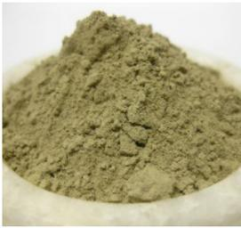
**Arcilla:** Roca sedimentaria que al mezclarse con agua forma una pasta moldeable que se endurece al secar o con cocción. Cruda se puede emplear para aplanados, terrados o fabricación de adobes, cocida se puede utilizar para fabricación de ladrillos, tejas y tabiques.
