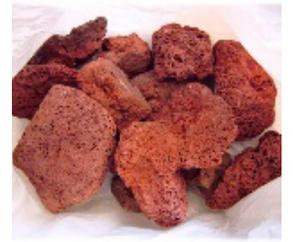
**Cantera:** Terreno del que se extrae la roca a cielo abierto, las piedras son de origen volcánicos y se encuentran principalmente en color negro, rojizo y gris. Se utilizan para los muros de mampostería con o sin mortero.
