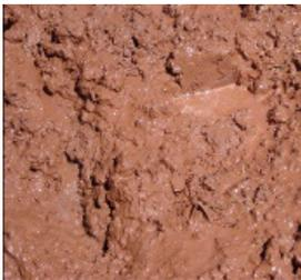
**Barro:** Material que se prepara mezclando la tierra con agua y algunas veces se le agrega estiércol o paja para tener una mejor consistencia. En muchas regiones se utiliza el barro para los cimientos o aplanados (embarro) o como entortado para el terrado.
