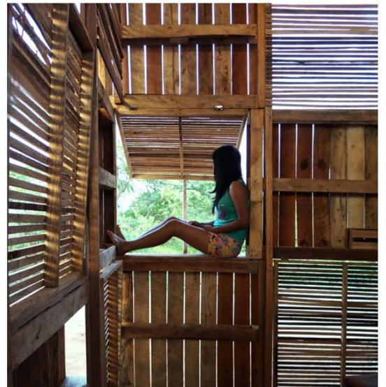
La vivienda se divide en 3 cuerpos, dos utilizados como dormitorio y uno utilizado como sala y cocina, con opción de crecimiento, las estructuras se protegen de la humedad al estar levantadas del terreno, los espacios abiertos permiten la ventilación cruzada todo el tiempo.
