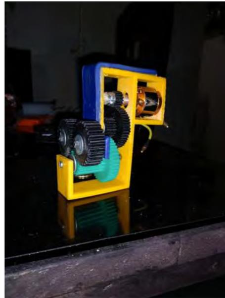
*Imagen 55 Caja reductora de velocidad*
