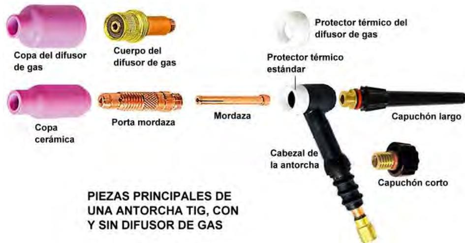
*Figura 2.2 Piezas que componen la antorcha para soldadura TIG.
