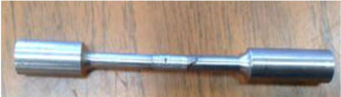
*Figura 4.1 Probeta de soldadura para la prueba de tensión.*
