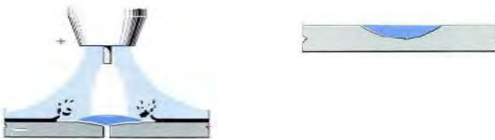
**Figura 5.4** La corriente continua con polaridad inversa da un baño muy limpio pero la penetración es reducida C.C polaridad inversa Penetración reducida- cordón ancho
