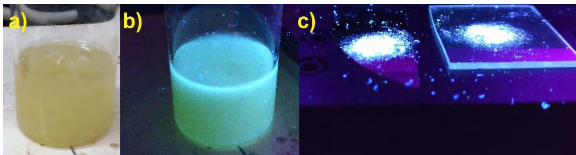
Figura 16: Suspensión de [AH]_2PbCl_4 en tolueno-DMF a) bajo luz natural y b) bajo luz UV de onda larga \lambda=325 nm. c) Sólido seco sobre láminas de silicio y de vidrio, emisión bajo luz UV de onda larga \lambda=325 nm
