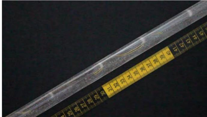
**Figura 4.8.** Fotografía donde se aprecia el Patrón de flujo intermitente de bache de líquido.
