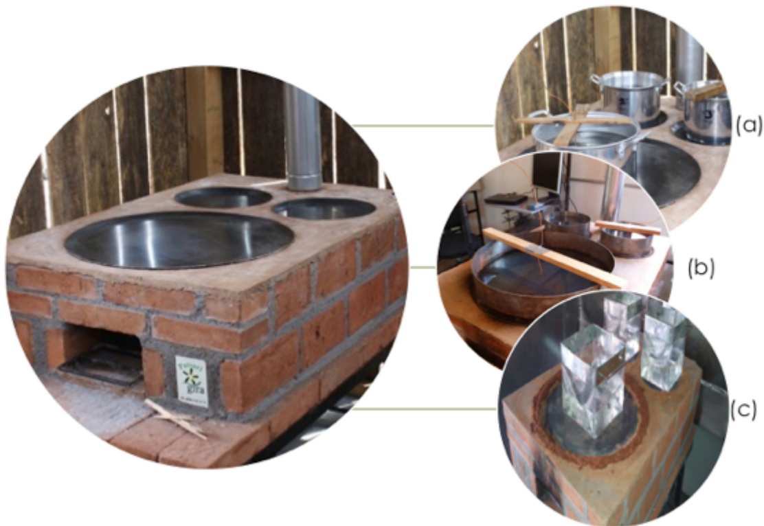
Figura 7. Diferentes recipientes utilizados en la prueba WBT para maximizar la transferencia de calor y determinar la máxima eficiencia térmica que presenta una estufa de leña con plancha. Ollas de aluminio (a), Comal-olla (b) y Ollas de Mylar (c). Créditos de figura: Víctor Ruiz.
