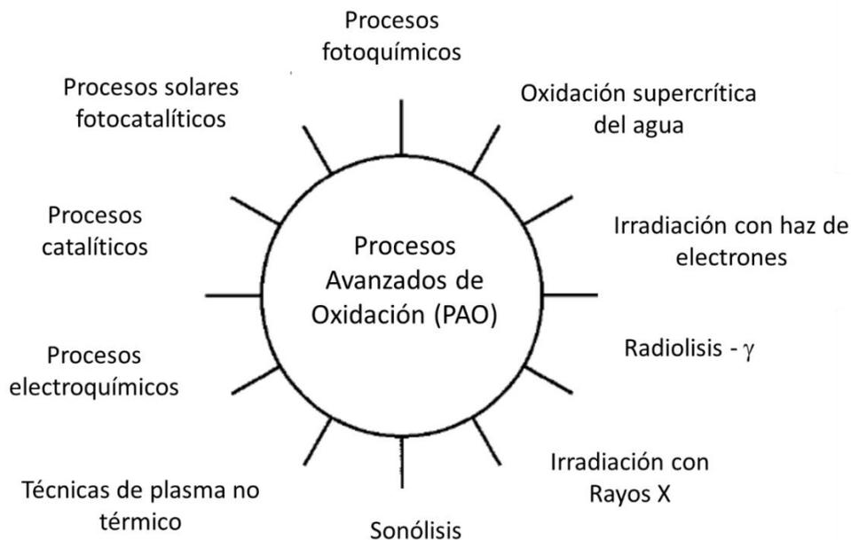
Figura 2.1 Procesos avanzados de oxidación para la eliminación de contaminantes presente en el agua y el aire.
