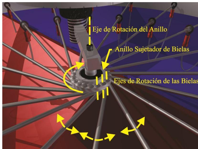
**Figura 2.12.** Movimiento de las Bielas con Respecto al Anillo Sujetador de Bielas.
