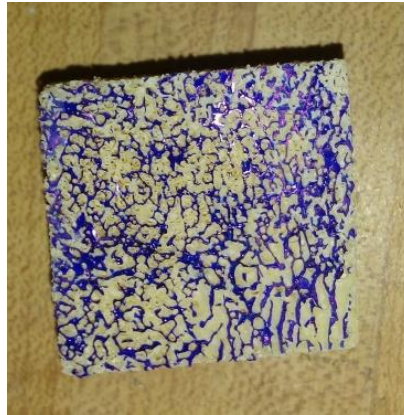
Figura 4.7 Entintado de la estructura
