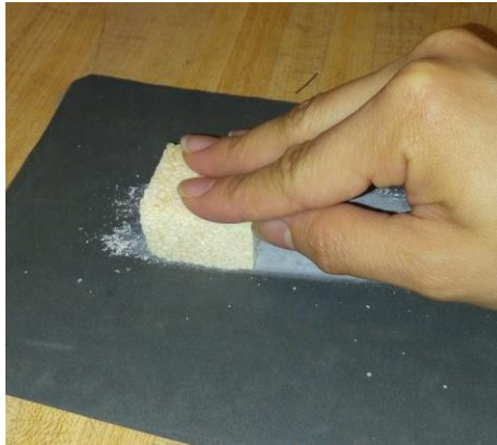
Figura 4.6 Lijado inicial de una probeta de húmero equino
